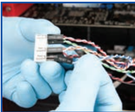
شکل ۱۹-۸ نصب و اتصال کانکتورهای پانل جلوی کیس
