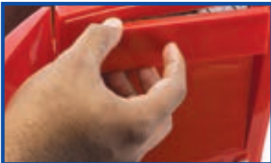
شکل ۲۰-۸ برداشتن پانل جلوی کیس
