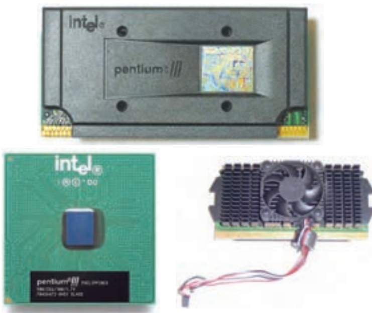
شکل ۳-۳۳ پردازنده پنتیوم III با ساختار شکاف ۱ (بالا)، پروانه
