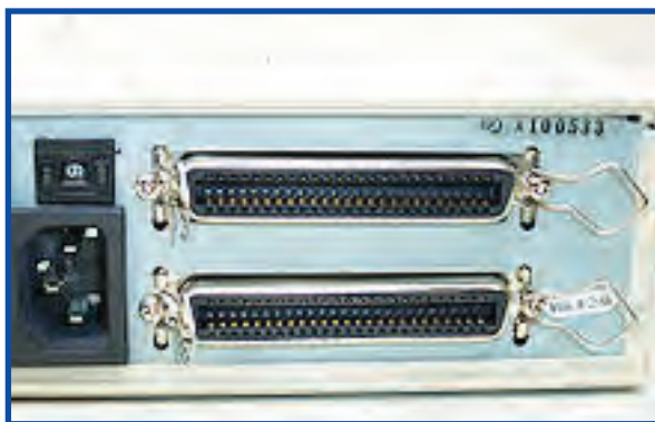
شکل ۴-۴۶ کانکتور اسکازی روی دیسک سخت خارجی
