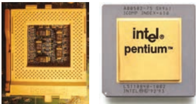
شکل ۲۸-۳ پردازنده پنتیوم ۷۵ و سوکت شماره ۵
