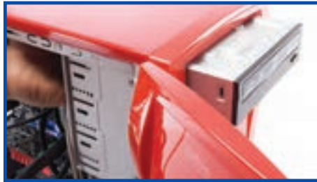
شکل ۸-۲۱ استقرار دیسک گردان نوری
