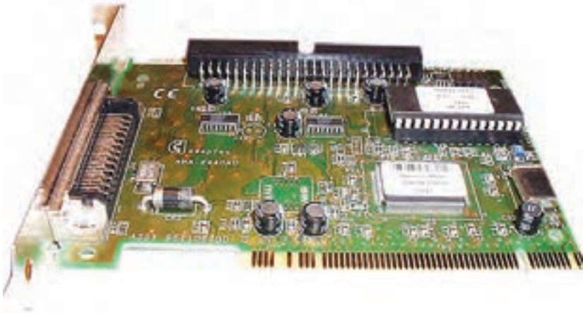
شکل ۵۲-۴ کارت رابط اسکازی SCSI
