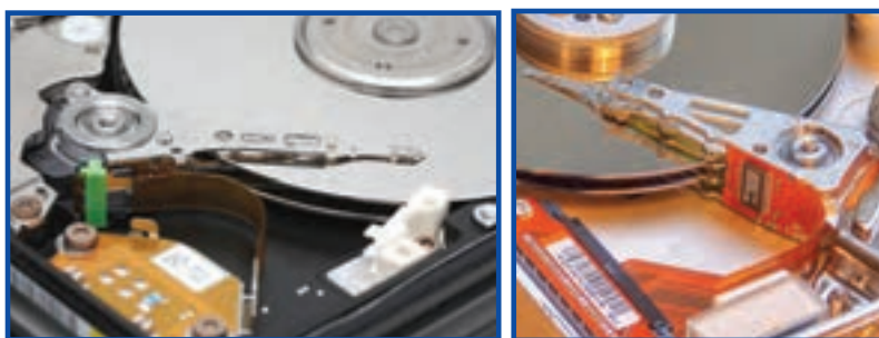
شکل ۴-۳۱ هد خواندن و نوشتن در دیسک سخت با دو صفحه
