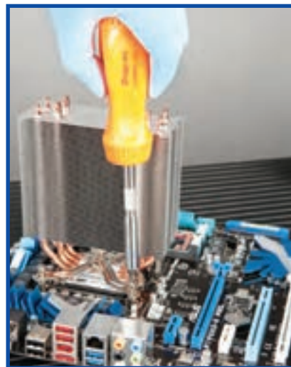
شکل ۸-۸ نمونه‌ای از نصب پایه خنک کننده
