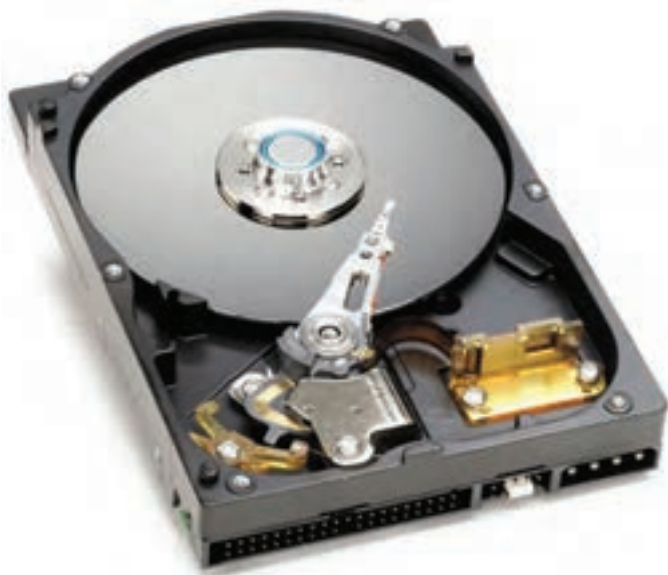
شکل ۲۹-۴ نمای داخلی دیسک سخت
