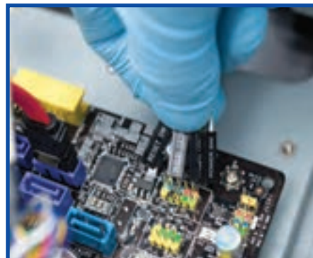
شکل ۱۹-۸ نصب و اتصال کانکتورهای پانل جلوی کیس
