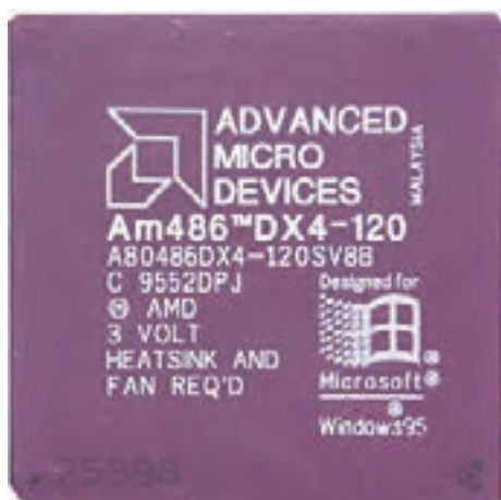
شکل ۳-۲۵ پردازنده AM486 DX4 از شرکت AMD مشابه خانواده DX 486 Intel با سرعت ۱۲۰ مگاهرتز
