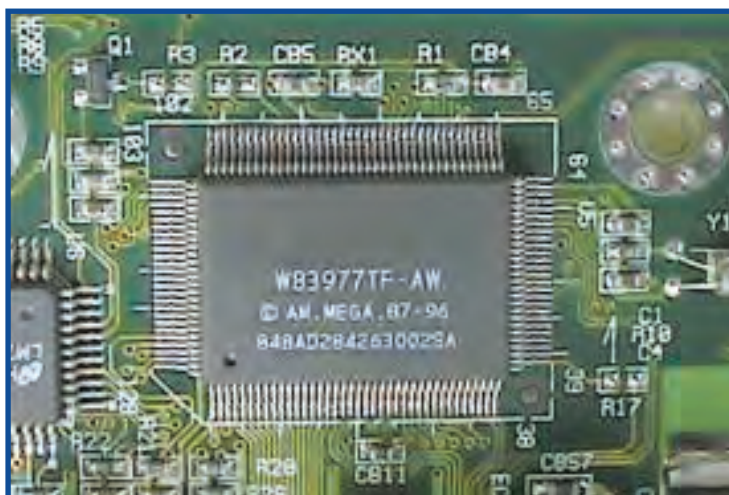
شکل ۳۷-۲ تراشه مجموعه ورودی / خروجی (Super I/O)
