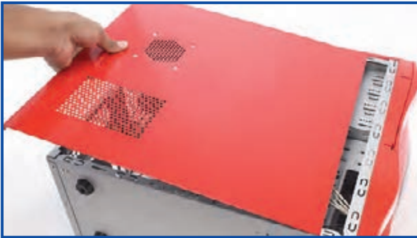
شکل ۸-۱ برداشتن قاب‌های جانبی
