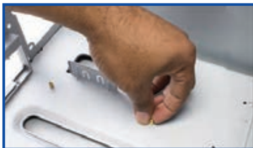
شکل ۸-۱۲ ثابت کردن پایه‌های برنجی
