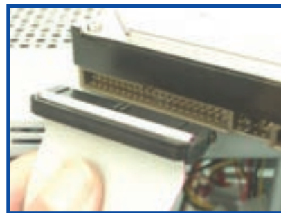
شکل ۸-۲۲ نصب کابل IDE
