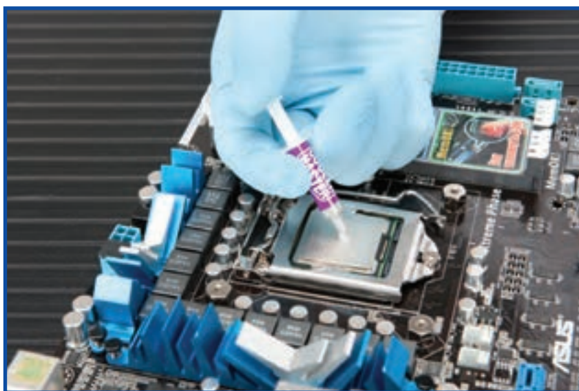
شکل ۷-۸ پوشاندن پردازنده با خمیر انتقال حرارت
