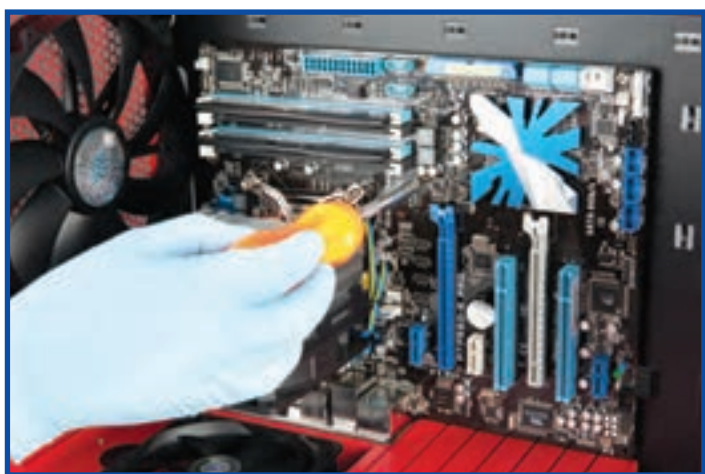
شکل ۸-۱۵ بستن پیچ‌های برد اصلی
