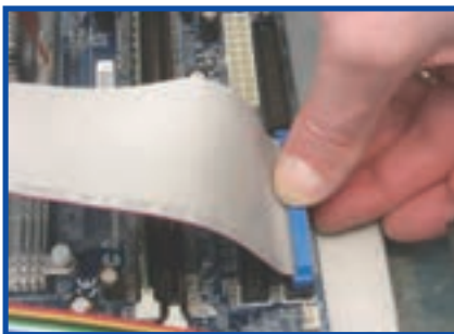
شکل ۸-۲۲ نصب کابل IDE
