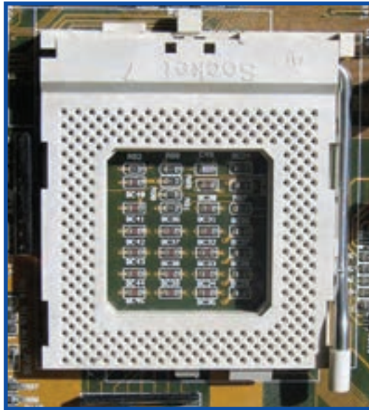
شکل ۶-۲ سوکت پردازنده از نوع ZIF
