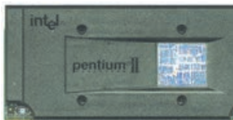
شکل ۳-۳۱ جلو و پشت پردازنده پنتیوم II با دو تراشه حافظه نهان و به صورت شکاف ۱
