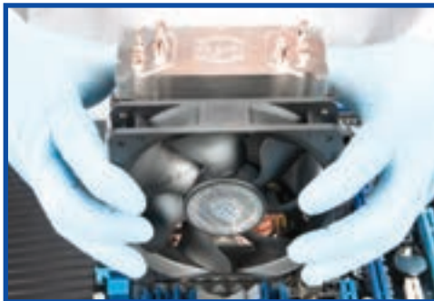
شکل ۸-۹ نصب خنک کننده پردازنده
