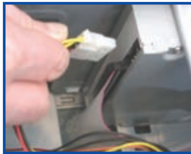
شکل ۲۳-۸ اتصال کابل برق دیسک گردان نوری
