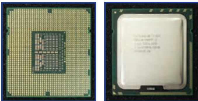
شکل ۳۷-۳ جلو و پشت پردازنده Intel core i7-975
