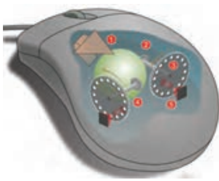
شکل ۲۶-۶ درون ماوس مکانیکی - نوری
