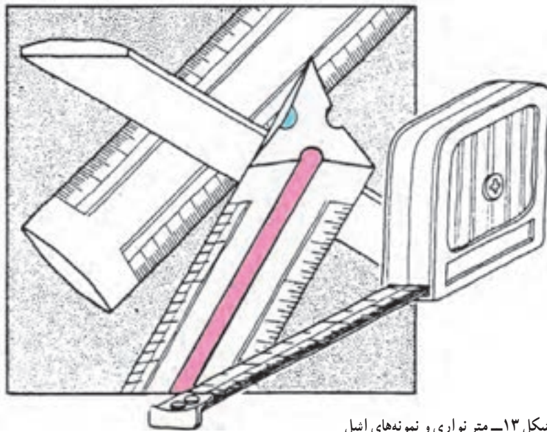
شکل ۱۳- متر نواری و نمونه‌های اشل
