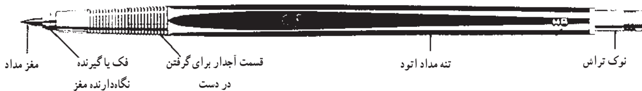
شکل ۷- مداد اتود و قسمت های مختلف آن
