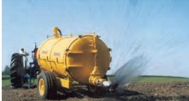
شکل ۱۲-۵- کود دهی به زمین با مایع پاش
