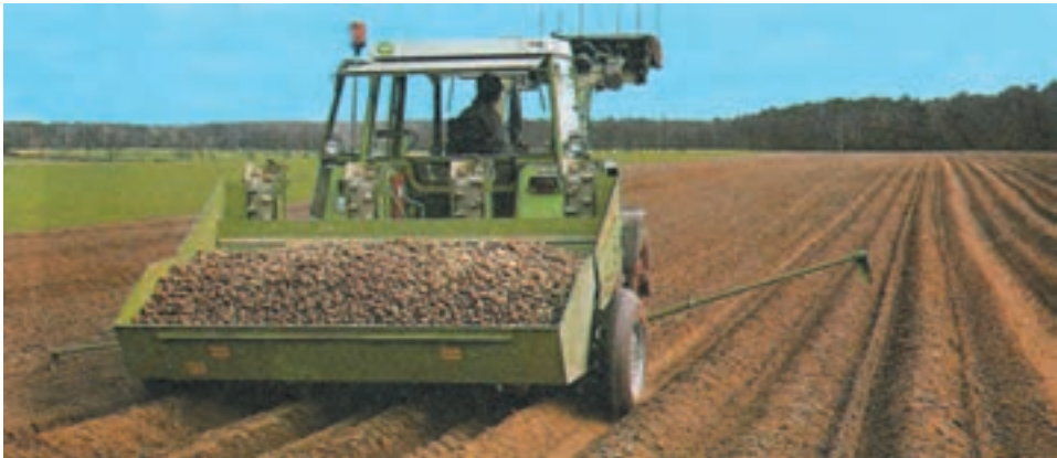
شکل ۱-۶- سیب‌زمینی کار چهار ردیفه در حال کاشت
