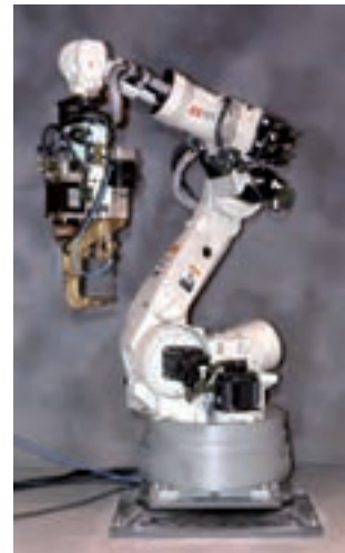
(ت) روبات جوشکار، جوش مقاومتی
