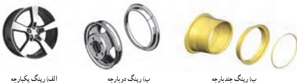
شکل ۱۱-۱۰ انواع رینگ یکپارچه، دوپارچه و چندپارچه
