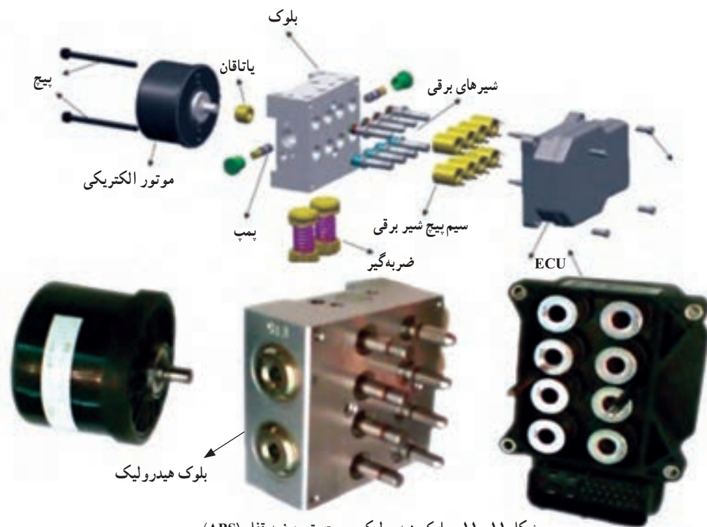
شکل ۱۱-۱۱- بلوک هیدرولیک سیستم ترمز ضد قفل (ABS)
