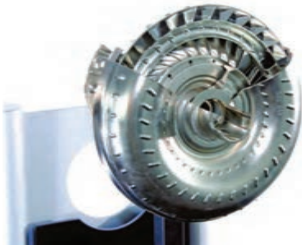
شکل ۵-۲- اجزای داخلی مبدل گشتاور
