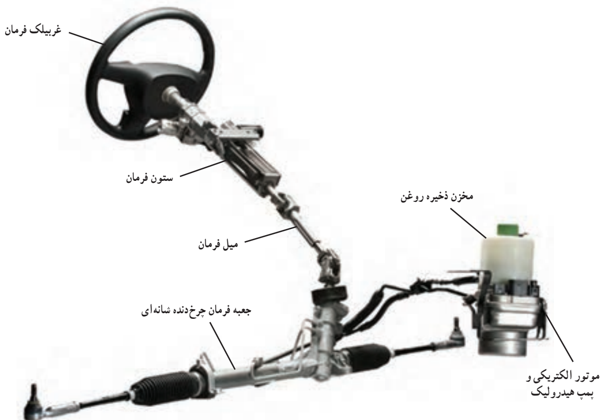
شکل ۱۹-۸- ساختمان ظاهری فرمان الکترو هیدرولیکی
