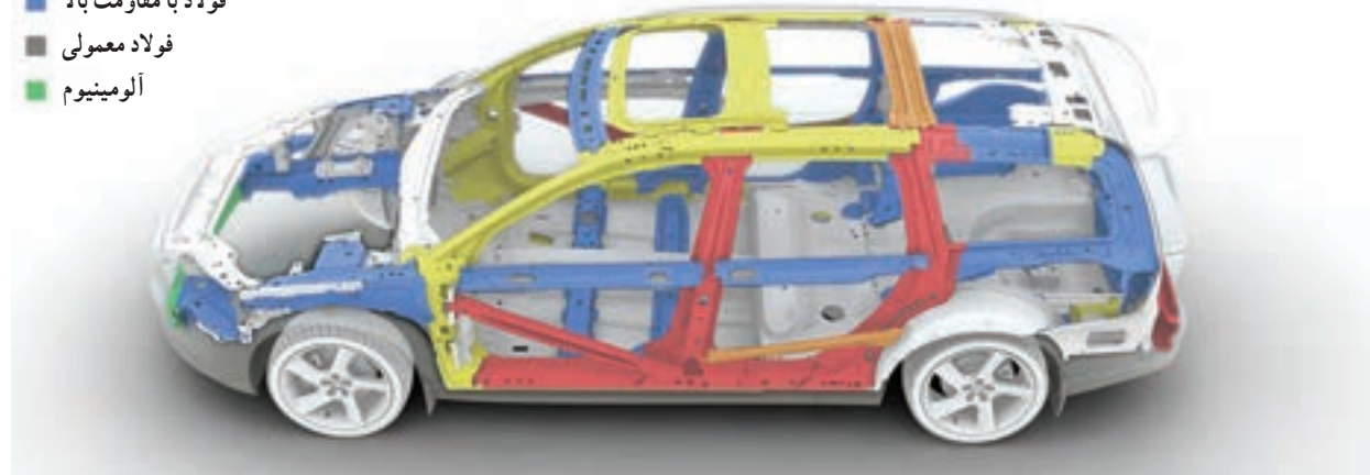
شکل ۱۱-۱- استفاده از ورق هایی با قابلیت انعطاف در قسمت جلو و عقب خودرو و نیز ورق هایی با استحکام بالا در اطراف محفظه سرنشین
