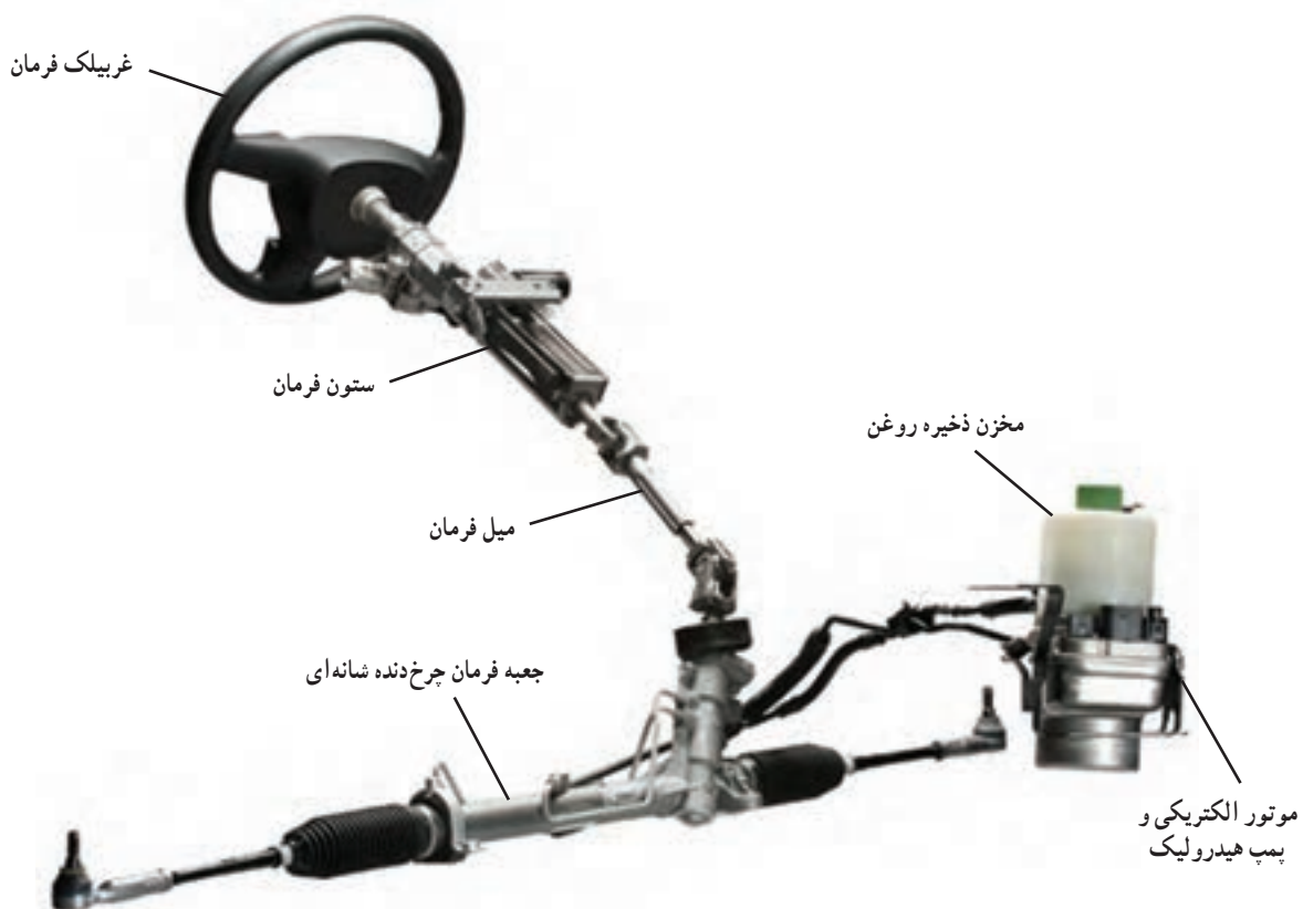
شکل ۱۹-۸- ساختمان ظاهری فرمان الکترو هیدرولیکی
