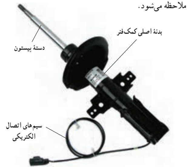
شکل ۷-۲۴- ساختمان ظاهری کمک فتر قابل تنظیم پیوسته از نوع ام آر (MR)
