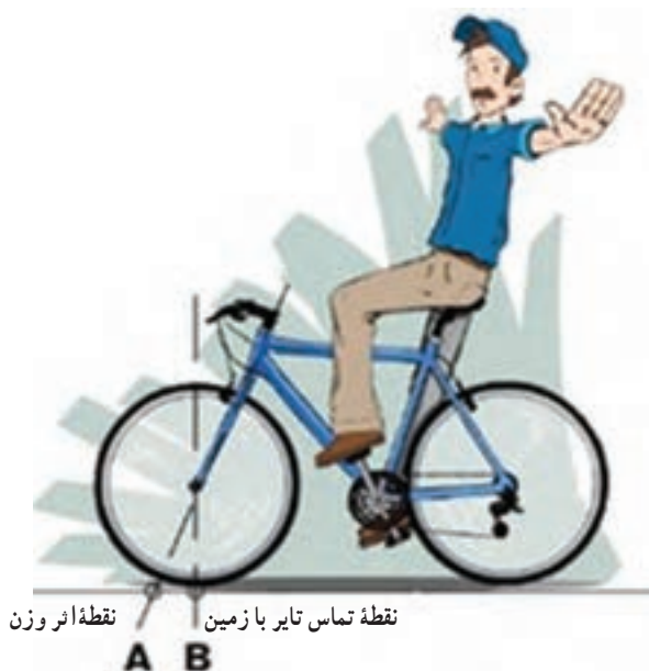
شکل ۷-۱۴- تأثیر زاویه کستر مثبت در پایداری سویی خودرو
