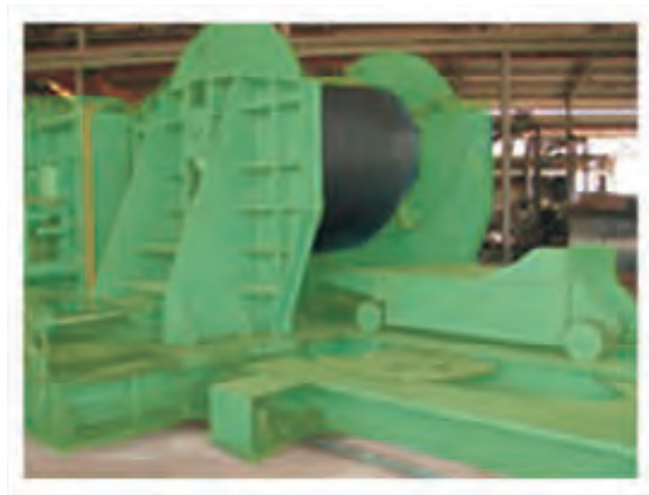
شکل ۴-۱۸ واحد باز کردن ورق ها
