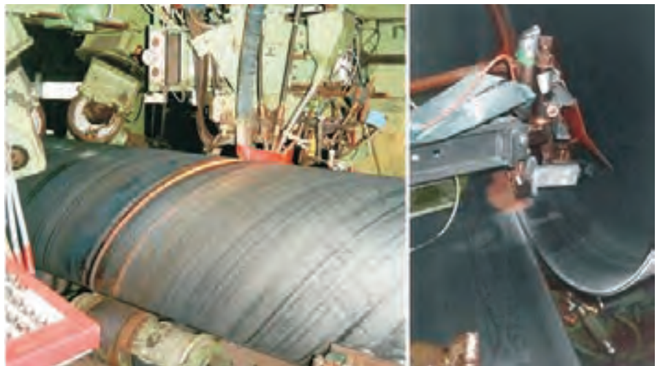
شکل ۴-۲۵-ب جوشکاری خارج لوله
