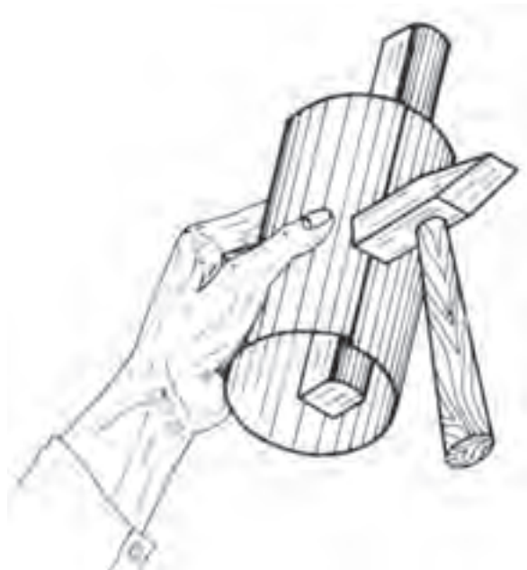
شکل ۶-۲۱ انطباق لبه‌های استوانه به کمک چکش و سندان
