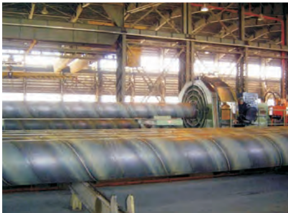
شکل ۴-۳۳ پخ کردن دو انتهای لوله
