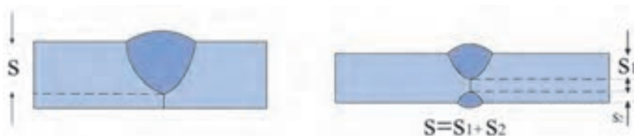
شکل ۲-۸- اندازه مؤثر در جوش شیاری با نفوذ جزئی
