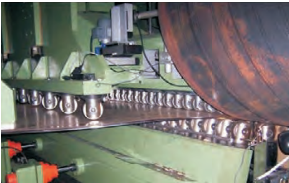
شکل ۴-۲۳-ج شکل دهی لوله‌ها
