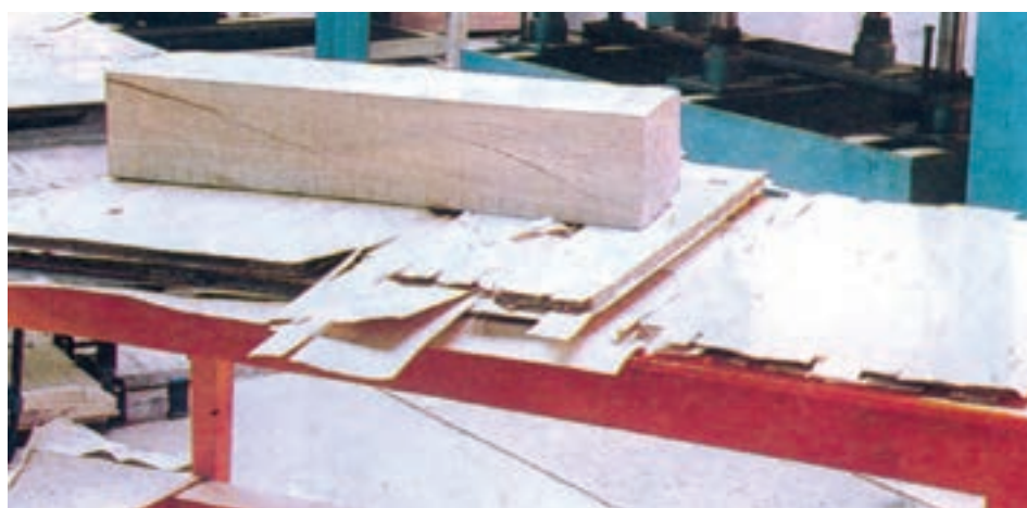
شکل ۷-۳۱- گذاشتن وزنه روی سطح کار روکش شده داغ
