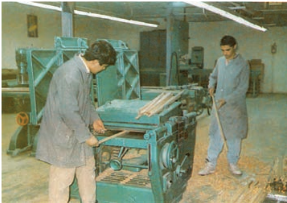
شکل ۴-۷۷- شاخص مدرج در یک ماشین دوکاره رنده گندگی
