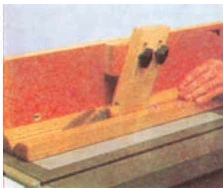
شکل ۳-۶۱- برش زهوار گرد به وسیله‌ی ارّه گرد با کمک شابلون یا فیکسچر مخصوص شانه‌ای
