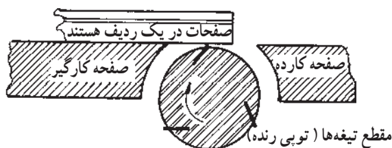
شکل ۱۰-۴- در این وضعیت چوب رنده نمی‌شود
