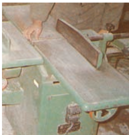
شکل ۴-۲۹ - بعد از تنظیم گونیا تویی را بگردانید تا از صحت تنظیم مطمئن شوید.
