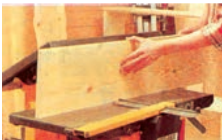
شکل ۴-۳۹- طریقه رندیدن ضخامت صفحات نازک
