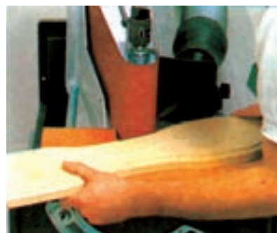
شکل ۷-۱۲- نحوه سنباده زدن قوس‌های مقعر
