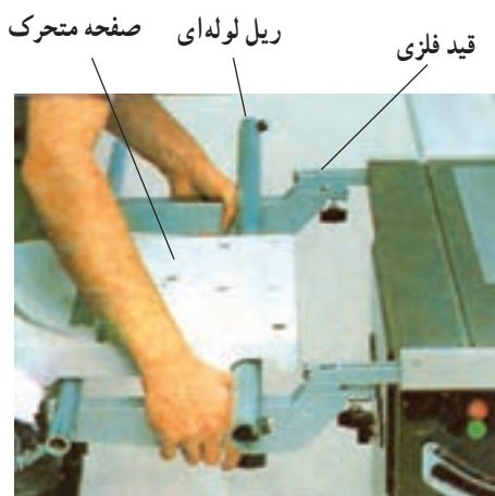
شکل ۳-۳۵ - طریقه نصب میز کشویی
