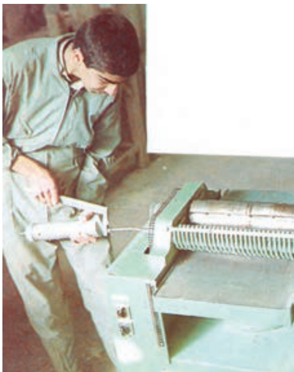
شکل ۴-۷۱- گریسکاری غلتک‌های گندگی
