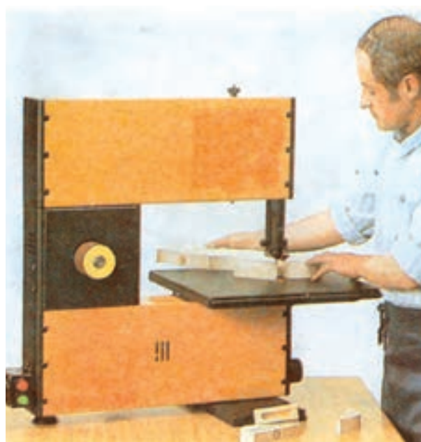
شکل ۲-۷۶- عملیات قوس‌بری صفحات
