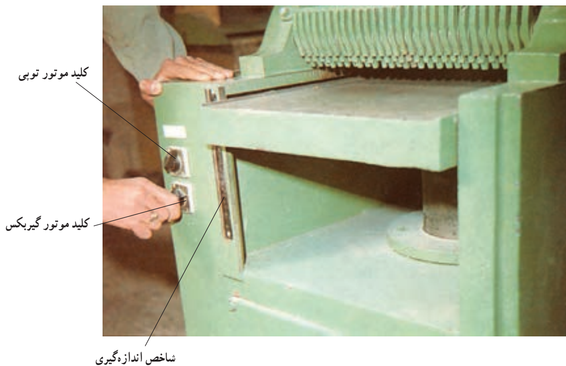
شکل ۴-۷۵- نحوه روشن کردن از کنار ماشین گندگی
