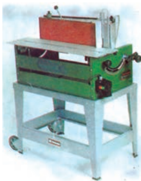
شکل ۴-۱۲- ماشين سنبلاده نواى غلتكى عمودى
