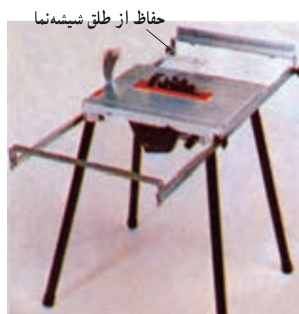
شکل ۳-۳۴ - استفاده از حفاظ پلاستیکی روی تیغه
