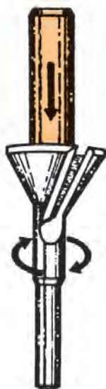
شکل ۷-۱۰ - نحوه پخ زدن سر دویل با مته مخصوص
