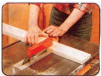
شکل ۳-۶۳- برش عرضی چوب با ارّه گرد
