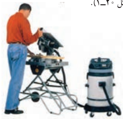
شکل ۲۰-۱- مکنده خاک اره موضعی برای هر ماشین
