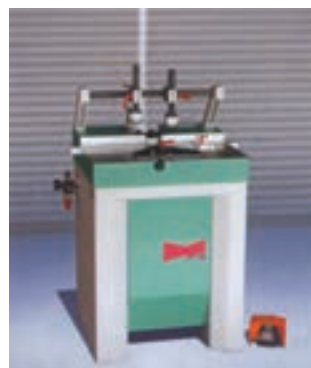
شکل ۹۴-۹- ماشین فرز دم چلچله میزی
