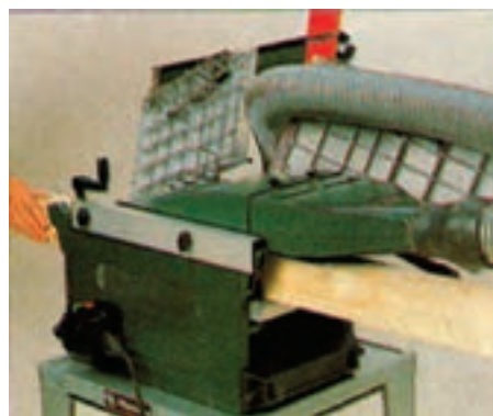
شکل ۸۲-۴ گندگی کردن چوب بلند با ماشین گندگی مجهز به مکند
