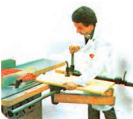
شکل ۳-۳۷- ماشین اره گرد میزی با میز متحرک کشویی
