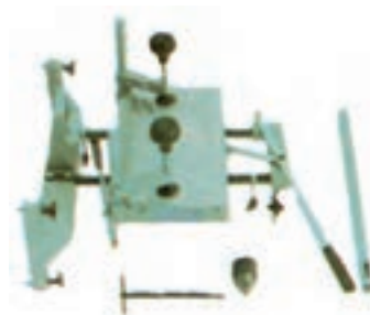
شکل ۹-۳۱- صفحه ماشین مته و اجزای آن
