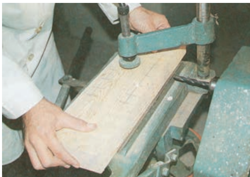
شکل ۹-۳۸- مستقر نمودن صفحه کار روی میز ماشین مته افقی
