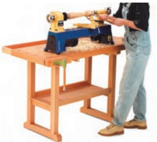
شکل ۱۴-۳- نحوه کار کردن با ماشین خراطی رومیزی
