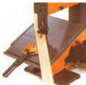
شکل ۲-۵۸- استفاده از گونیای فرعی در برش زاویه‌دار
