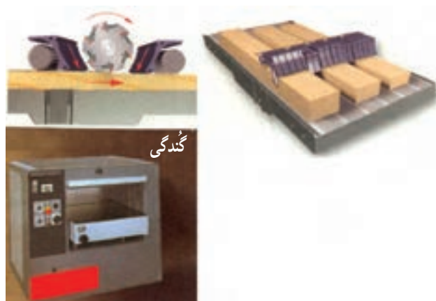
شکل ۴۳-۱- ماشین گندگی
