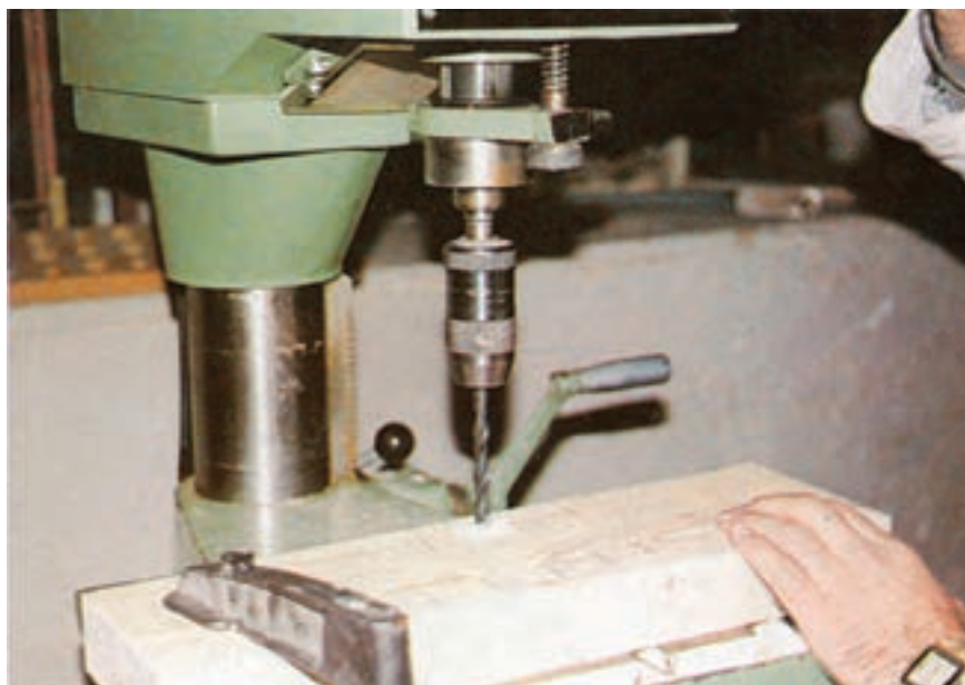
شکل ۹-۳۷- استفاده از گیره در استقرار صفحه روی میز ماشین مته
