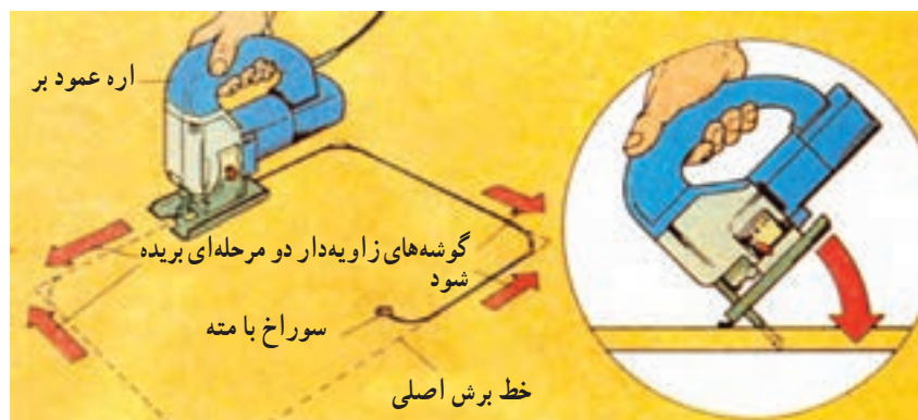
شکل ۲-۱۶- نحوه‌ی برشکاری وسط صفحات و برشکاری گوشه‌های کار با اره عمودبر
