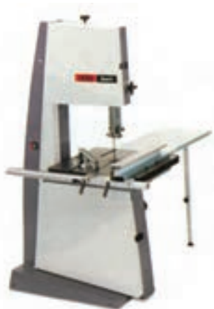
شکل ۳۱-۱- ماشین اره نواری با حفاظ کامل
