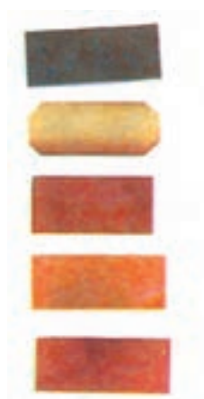
شکل ۱۴-۱۲- ورقه های کوچک سنباده به اندازه ۲۸۰×۱۱۵ میلی متر جهت سنباده لرزشی
