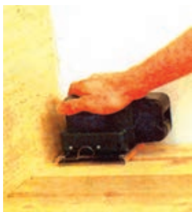
شکل ۲۱-۱۲ سنباده زدن گوشه‌های کار با سنباده لرزشی
