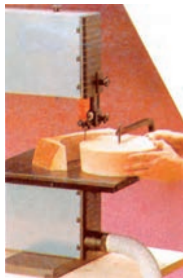
شکل ۶۸-۲ عمل دایره‌بری با استفاده از شابلون پایه‌دار
