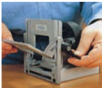
شکل ۹-۱۱۰- نحوه تنظیم زاویه گونیا
