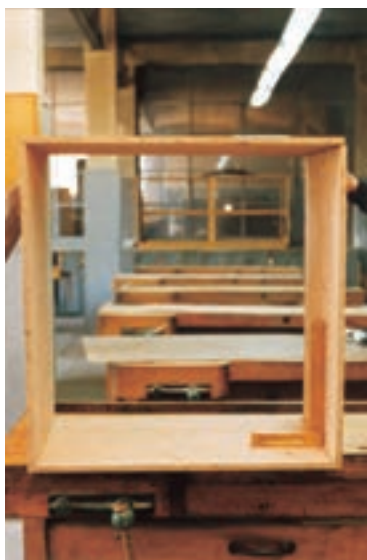
شکل ۱۱-۲۶- کنترل زوایای کار مونتاژ شده
