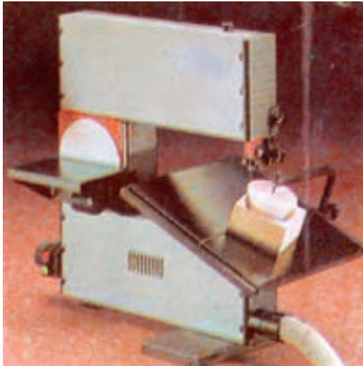
شکل ۶۹-۲ عمل مخروط‌بری با کمک شابلون پایه‌دار و کج کردن صفحه ماشین اره
