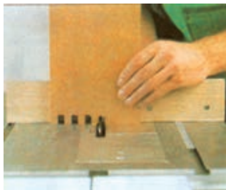
شکل ۳-۵۴- ایجاد اتصال انگشتی با ارّه لنگ
