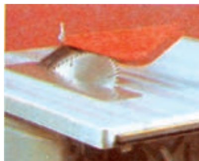
شکل ۳-۶- تیغ کج شونده تا ۴۵ درجه
