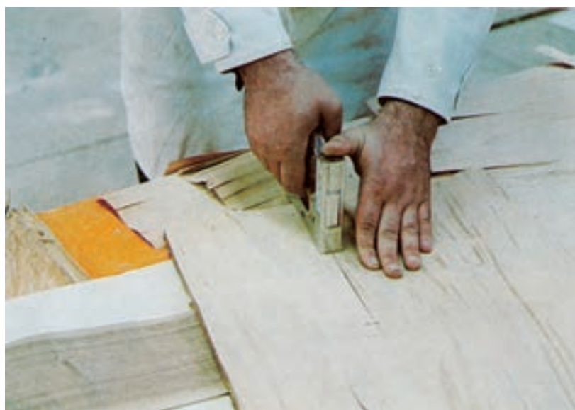
شکل ۵-۱۲- نحوه‌ی استفاده از دستگاه دوخت دستی در به هم دوختن روکش‌های درز شده
