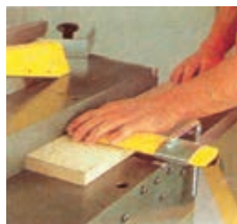
شکل ۴-۴۲- چوب از زیر حفاظ عبور داده شده
