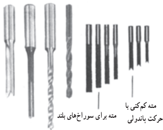
شکل ۹-۱۳ مته های مخصوص چوب با فولاد WS
