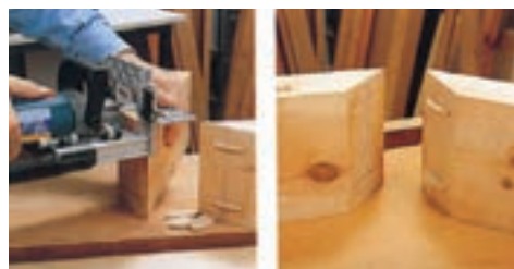
شکل ۹-۱۱۲ نحوه استفاده از گونیای ۹۰° دستگاه در اتصال زاویه دار دو چوب
