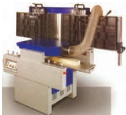
شکل ۱-۴۰- حفاظ ماشین گندگی مجهز به لوله مکنده می‌باشد.
