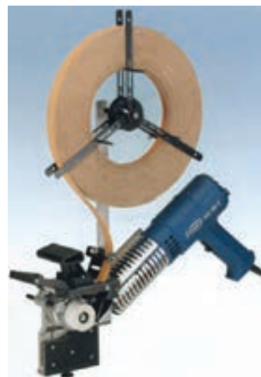
شکل ۶-۲۸- لبه‌چسبان با تکیه‌گاه یک طرفه
