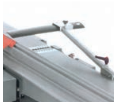
شکل ۴۲-۱- فاصله لبه دهانه میز رنده از تیغه
