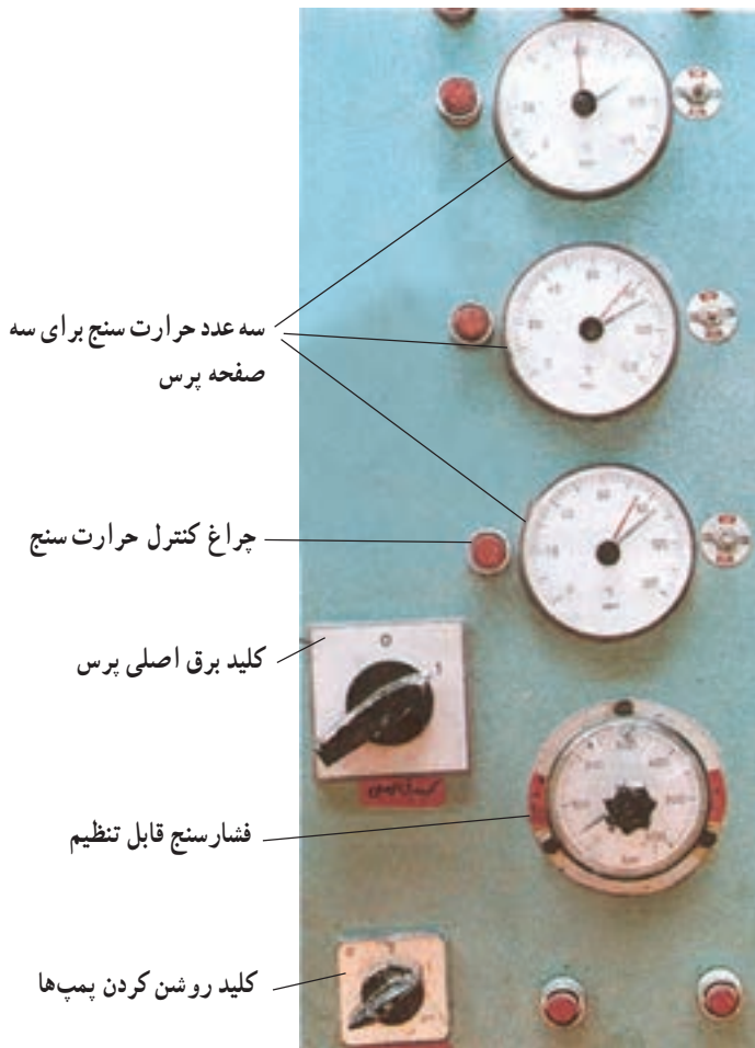
شکل ۷-۲۰- اجزای کنترل و تنظیم پرس
