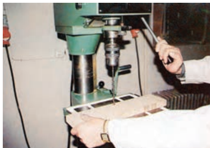
شکل ۵۲-۹- فرو کردن نیش مرکزی مته در مرکز سوراخ قبل از سوراخکاری
