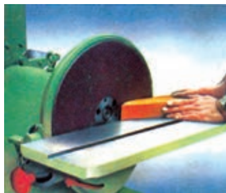
شکل ۸-۱۲- نحوه سنباده زدن قوس‌های محدب
