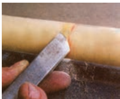
شکل ۱۴-۲۶- صاف و یکنواخت کردن سطح استوانه
