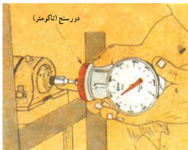
شکل ۲۴-۲ استفاده از سرعت سنج (تاکومتر) در دستگاه در حال کار
