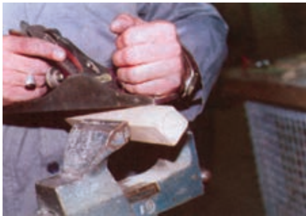
شکل ۳۰-۱۴- هشت ضلعی کردن چوب به وسیله رنده
