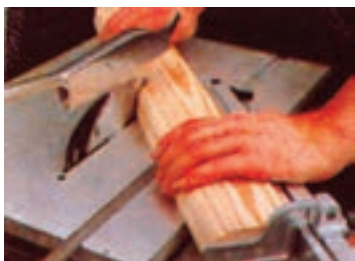
شکل ۳-۶۴- برش عرضی زاویه دار چوب پروفیل خورده
