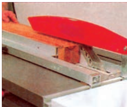
شکل ۷۲-۳- قطع طولی چوب با ارّه گرد
