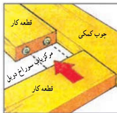
شکل ۸-۱۰- قطعه مرکز یاب سوراخ قطعه مجاور
