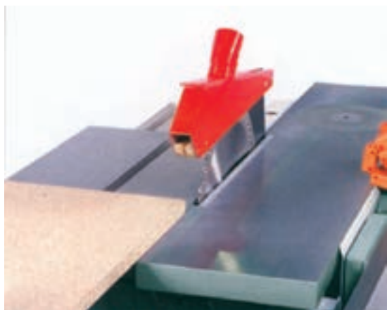
شکل ۱-۳۵- حفاظ روی تیغه اره مجموعه‌ای
