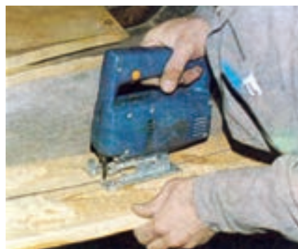
شکل ۲-۱۷- نحوه‌ی انجام برشکاری قطعات بزرگ بدون استفاده از گیره
