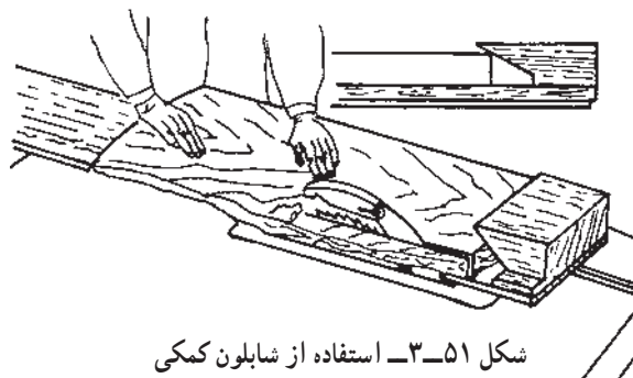
شکل ۳-۵۰- شابلون برای برش های طولی لبه صفحات بلند با ارّه گرد
