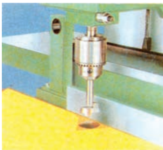
شکل ۹-۴۶- تنظیم عمق سوراخ جای لولا گزاری به وسیله ماشین مته عمودی
