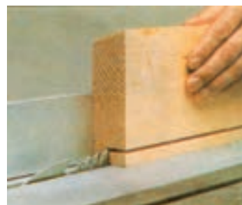
شکل ۳-۵۲- روش دو راهه زدن با ماشین ارّه گرد
