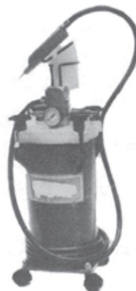
شکل ۹-۱۰- مخزن چسب مایع با پیستوله چسب زنی
