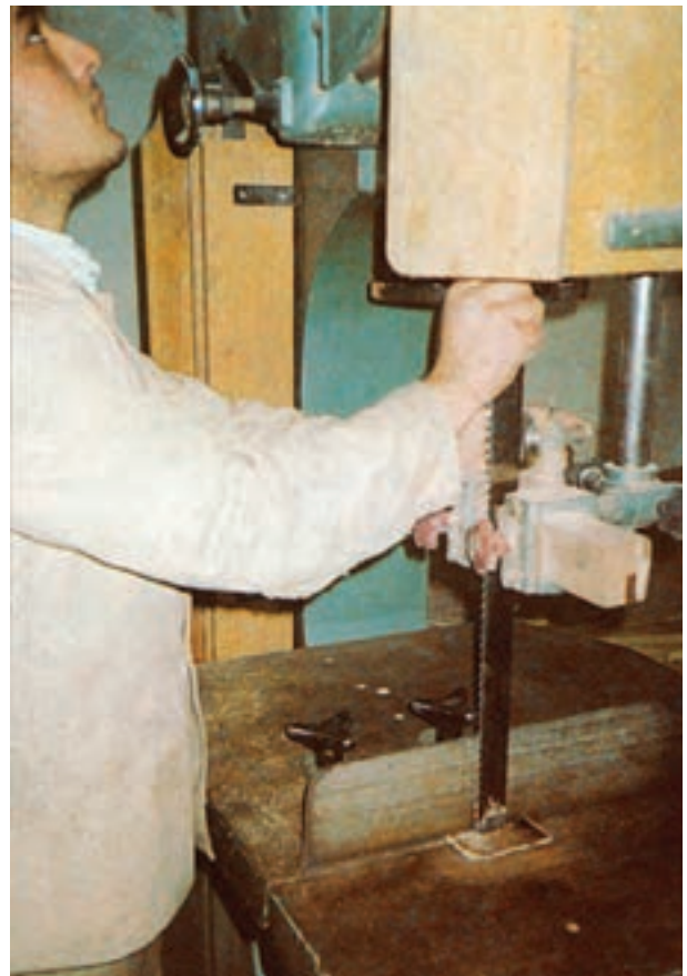
شکل ۲-۵ – هنرجوی هنرستان ابوریحان کرج در حال آزمایش تنظیم تیغه اره
