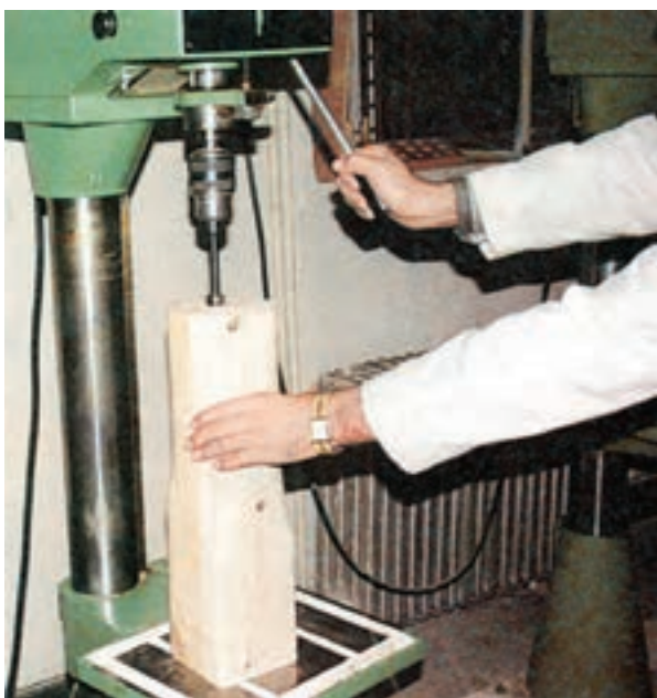
شکل ۹-۵۶- سوراخکاری قطعه بلند عمودی
