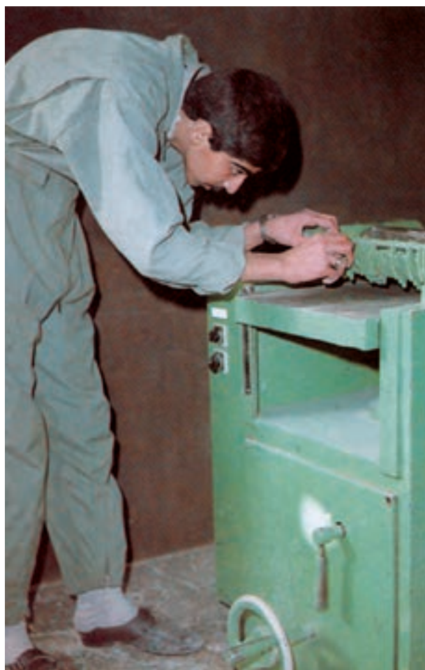
شکل ۴-۷۰- نحوه بررسی شانه فلزی حفاظت کننده ماشین
