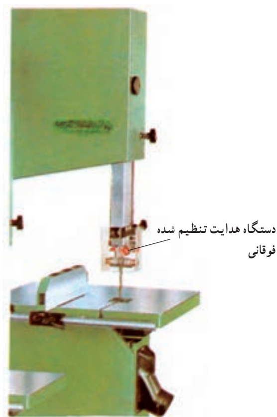
شکل ۲-۵۳- دستگاه هدایت تنظیم شده
