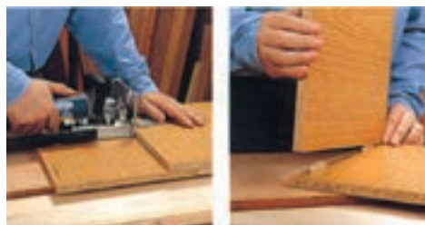
شکل ۹-۱۱۱ نحوه استفاده از گونیای ۹۰° دستگاه در اتصال دو صفحه
