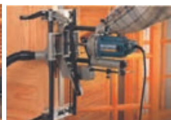
شکل ۷۸-۹- ایجاد شیار عمودی برای قفل مغزی
