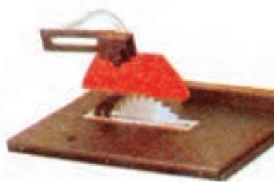
شکل ۳-۳۰- حفاظ روی پایه جداگانه است.
