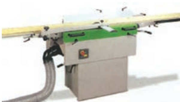
شکل ۴۰-۱- ماشین رنده مجهز به لوله مکنده است.
