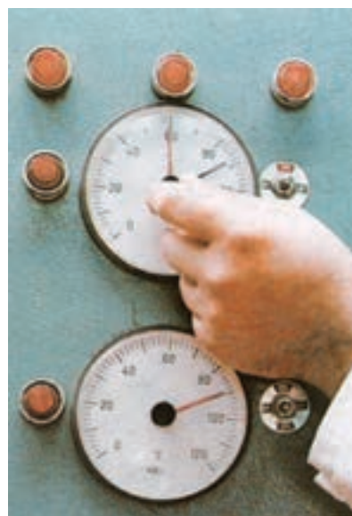
شکل ۷-۲۱ نحوه تنظیم حرارت سنج پرس
