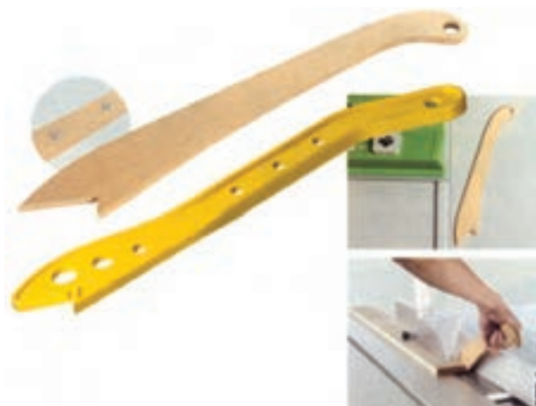
شکل ۱-۲۷- شابلون هل دهنده و نگهدارنده پشت چوب
