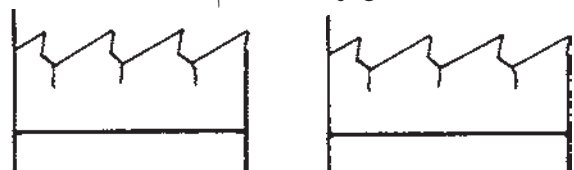
شکل ۴۱-۲- دندانہ ترک دار
