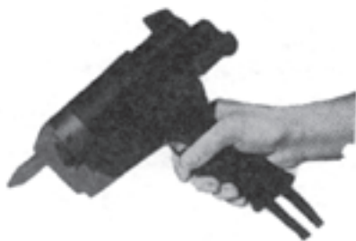
شکل ۱۰-۱۰- نحوه استفاده از پیستوله چسب زنی
