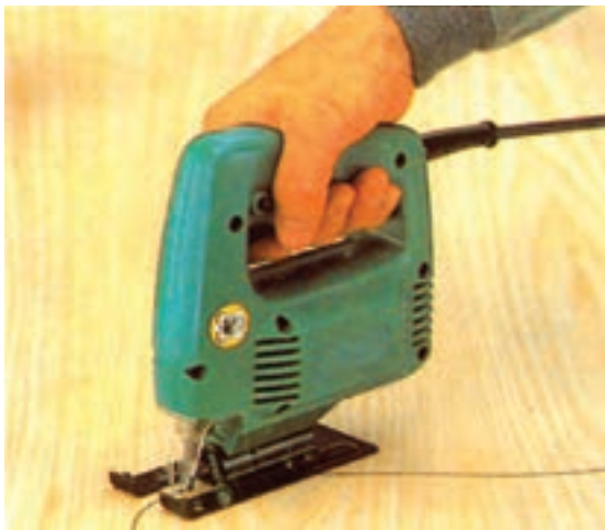
شکل ۲-۱۵- برش صفحات چوبی بدون استفاده از گونیا
