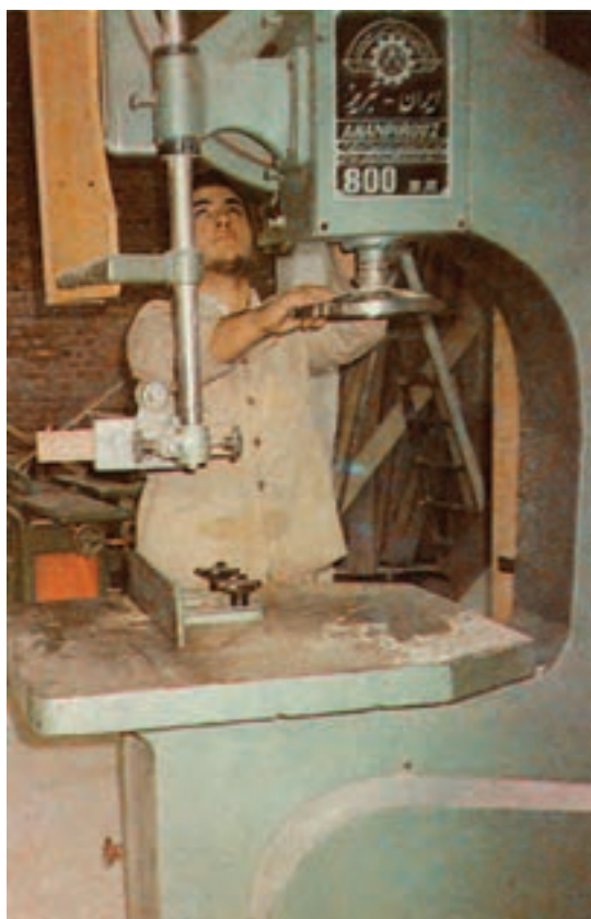
شکل ۲۹-۲- هرنجو در حال پایین آوردن فلکه ماشین اره نواری
