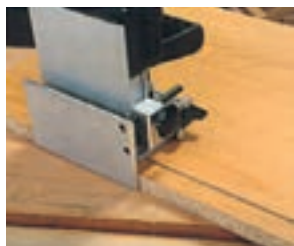
شکل ۹-۱۱۴ نحوه برش دادن صفحه‌ها
