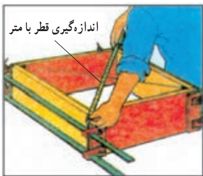
شکل ۱۱-۲۵- نحوه کنترل دویدگی با متر
