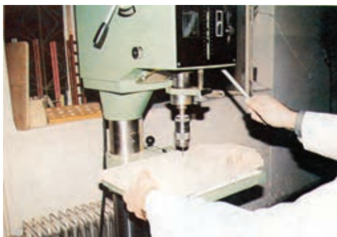
شکل ۵۳-۹- استفاده از صفحه کمکی زیر صفحه اصلی در سوراخکاری دوطرفه
