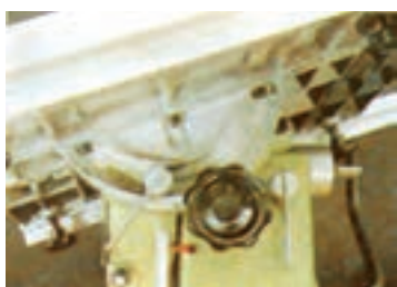
شکل ۳-۲۱- تنظیم صفحه کج شونده ماشین اَره گرد
