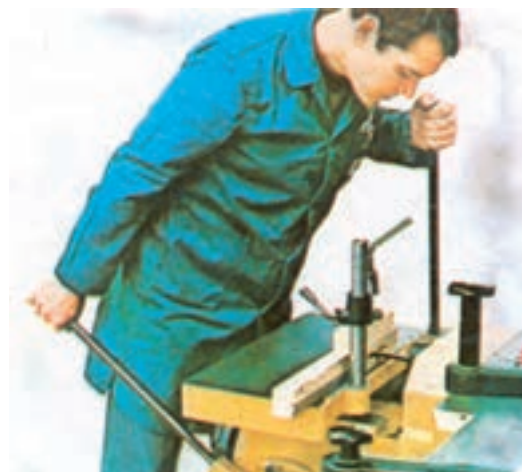
شکل ۹-۶۴- نحوه استقرار هنرجو در عملیات کام کنی
