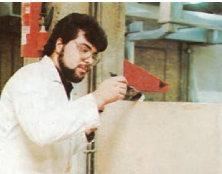
شکل ۶-۶ چسب زدن ضخامت صفحه تخته خرده چوب
