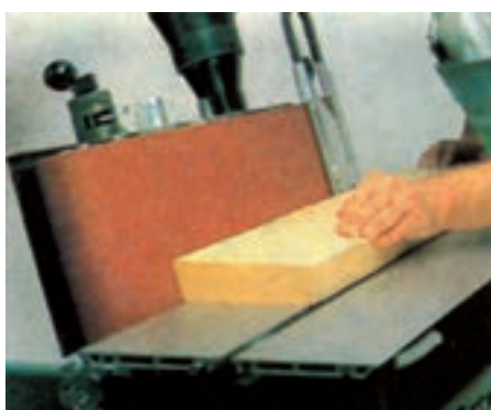
شکل ۵-۱۲- سنبلاده زدن نر صفحه با زاویه ۳۰ درجه
