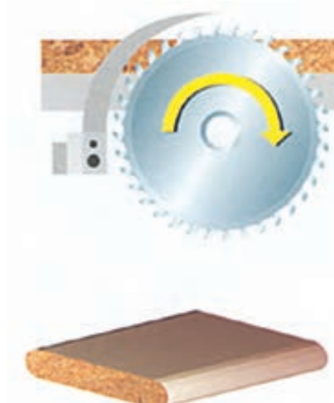
شکل ۱-۳۸- نحوه استقرار تیغه جدا کننده
