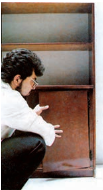
شکل ۸-۱۳- جاسازی و علامت‌گذاری برکه لولای روی کار
