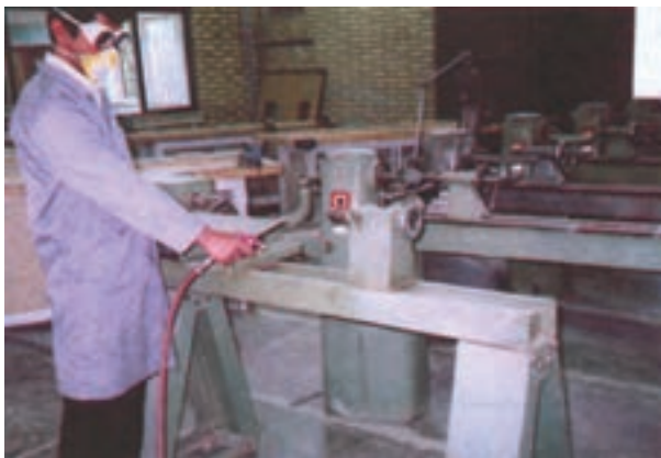
شکل ۱۴-۴۸- گردگیری و تمیز کردن ماشین خراطی با هوای فشرده صحیح نیست.
