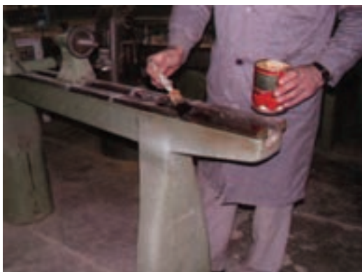
شکل ۱۴-۴۹- آغشته به نفت کردن بستر ماشین خراطی
