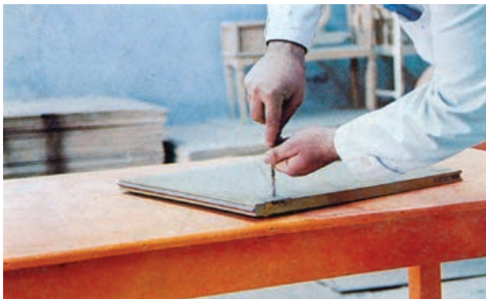
شکل ۷-۱۳- نصب یک عدد قفل سوئیچی
