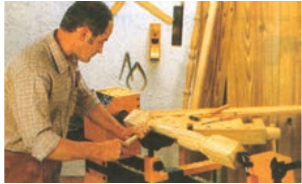
شکل ۱۷-۱۴- محور قطعه کار را موقع خراطی در امتداد محور مرگکها قرار دهید.
