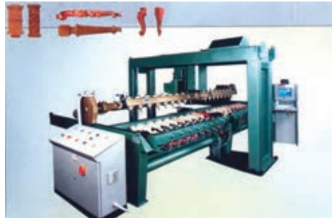
شکل ۷-۱۴- ماشین خراطی C.N.C رو میزی
