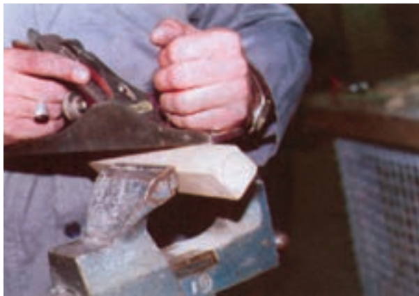
شکل ۳۰-۱۴- هشت ضلعی کردن چوب به وسیله رنده
