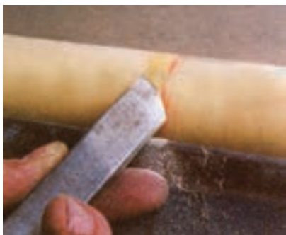
شکل ۱۴-۲۶- صاف و یکنواخت کردن سطح استوانه
