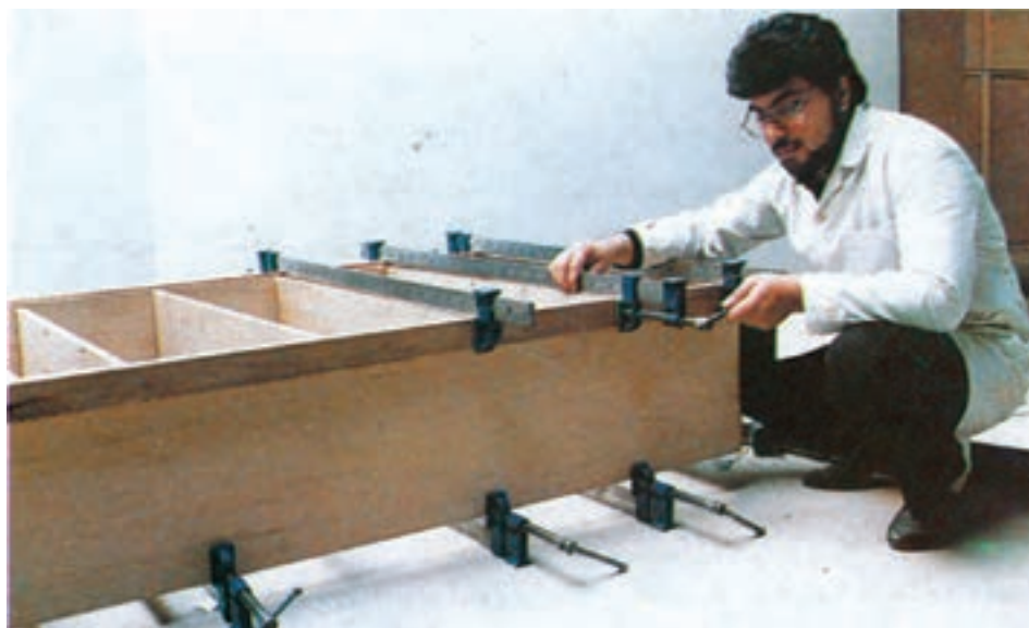
شکل ۲۲-۱۱- نحوه استقرار کتابخانه سر هم شده بین دهانه تنگ‌ها برای فشردن و چسباندن
