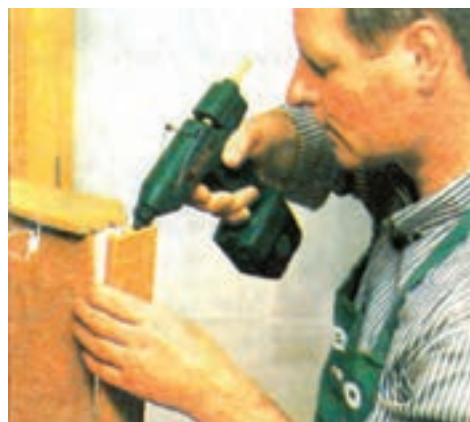
شکل ۱۴-۱۱- نحوه استفاده از چسب مخصوص گرم میله‌ای
