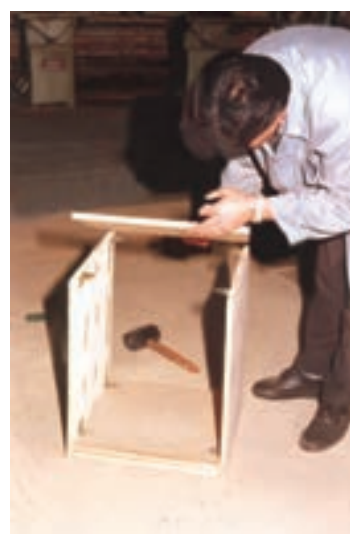
شکل ۲۱-۱۱- استفاده از چکش لاستیکی و چوب
