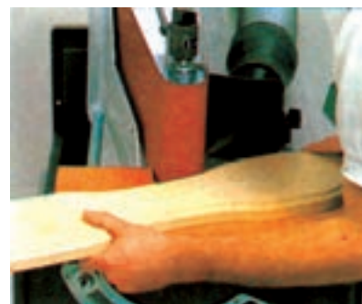
شکل ۷-۱۲- نحوه سنباده زدن قوس‌های مقعر
