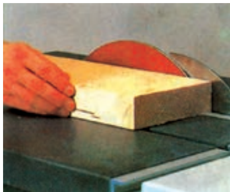
شکل ۹-۱۲- سنباده زدن نر صفحات با سنباده دیسکی
