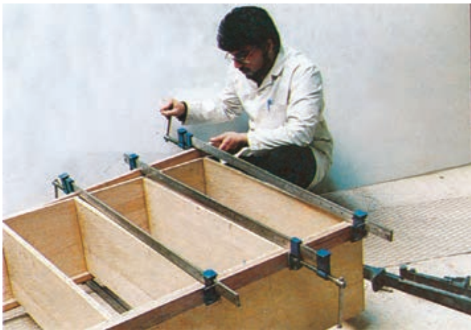
شکل ۲۳-۱۱- نحوه استقرار چوب بین سطح کار و تنگ و محکم کردن تنگ در عملیات مونتاژ کاری
