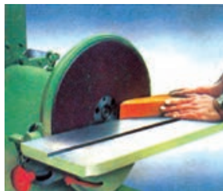
شکل ۸-۱۲- نحوه سنباده زدن قوس‌های محدب
