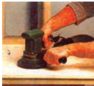
شکل ۱۲-۲۳- نحوه استفاده از سنباده دیسکی
