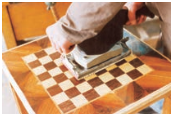
شکل ۱۲-۳۵- پرداخت کاری سطح صفحات به صورت افقی
