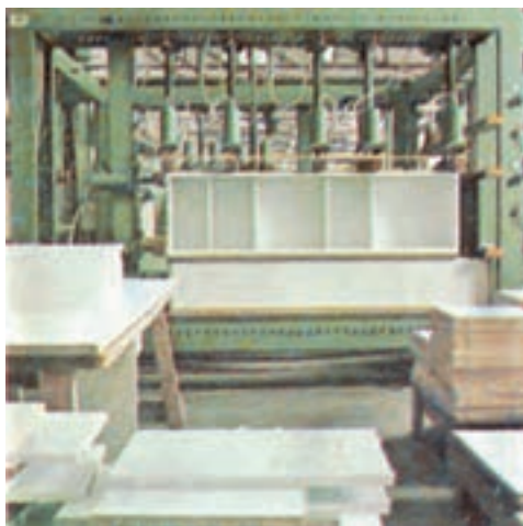
شکل ۲۰-۱۱ قسمت مونتاژ کابینت با تنگ پنوماتیک
