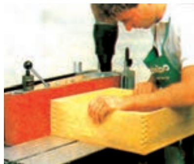
شکل ۶-۱۲- سنباده زدن و پرداخت کردن بدنه جعبه
