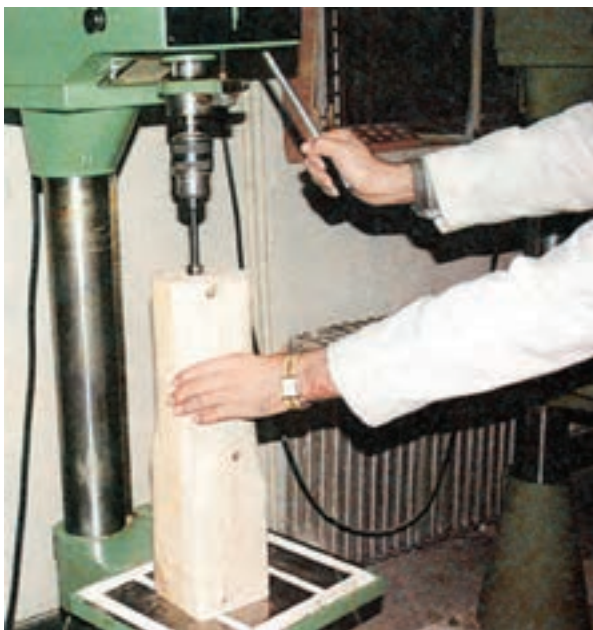
شکل ۹-۵۶- سوراخکاری قطعه بلند عمودی
