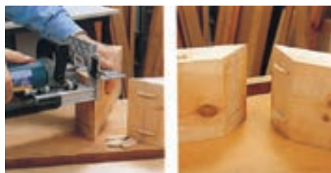
شکل ۹-۱۱۲- نحوه استفاده از گونمای ۹۰° دستگاه در اتصال زاویه دار دو چوب
