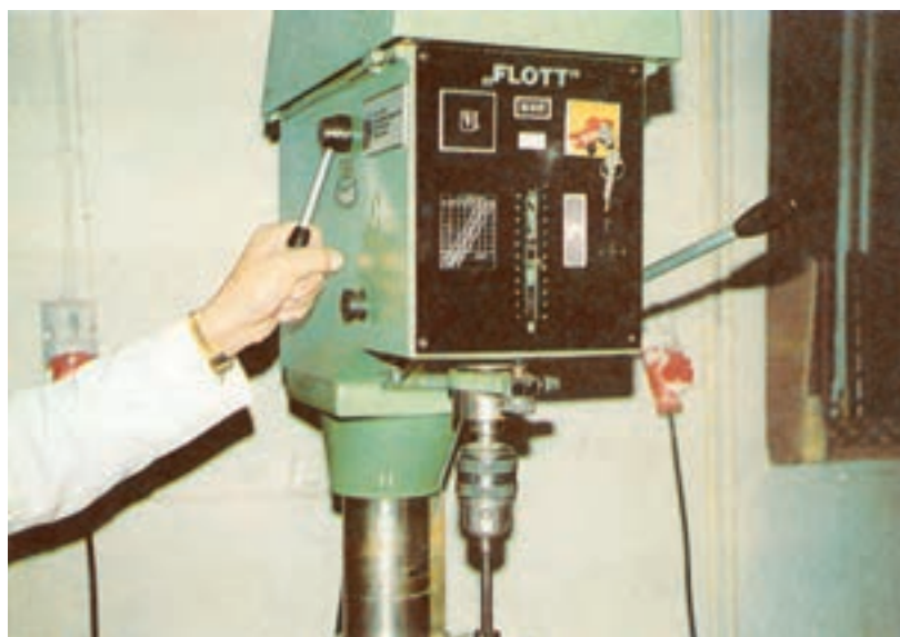
شکل ۵۰-۹- تنظیم دور مته در عملیات سوراخکاری
