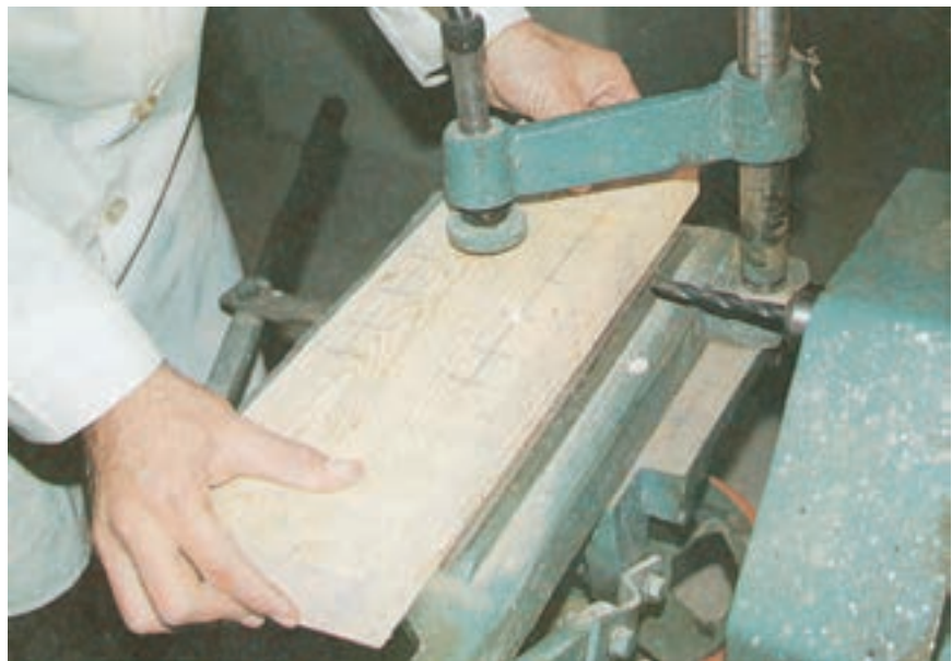
شکل ۳۸-۹- مستقر نمودن صفحه کار روی میز ماشین مته افقی
