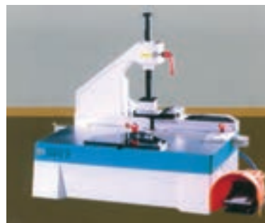
شکل ۹۶-۹ دستگاه فرز دم چلچله رومیزی پنوماتیک
