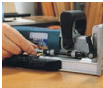
شکل ۹-۱۰۹- نحوه تنظیم عمق تیغه
