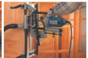
شکل ۷۸-۹- ایجاد شیار عمودی برای قفل مغزی
