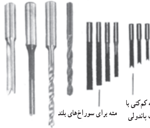
شکل ۹-۱۳- مته های مخصوص چوب با فولاد WS
