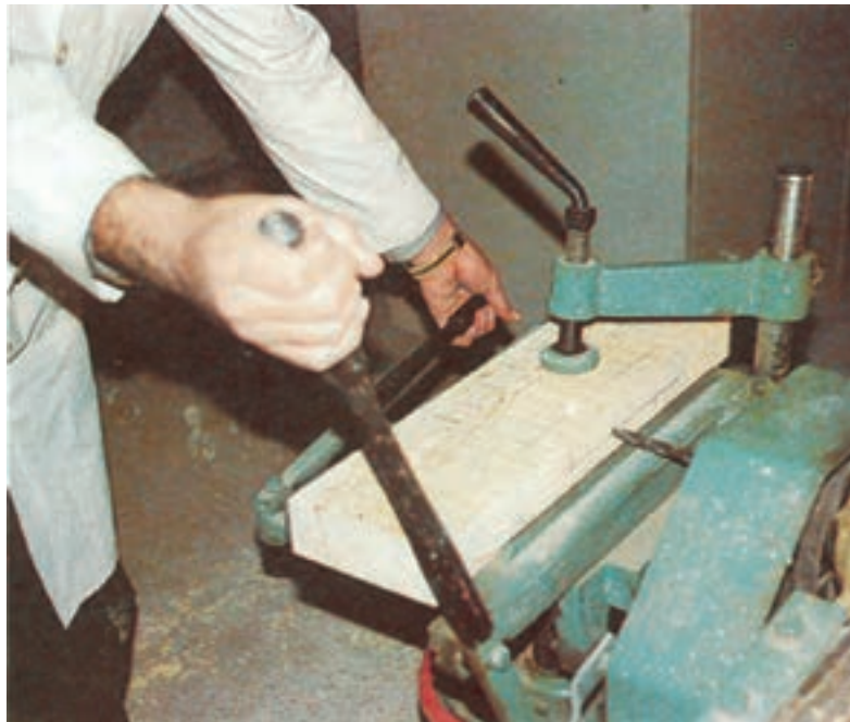
شکل ۹-۶۱- نحوه استفاده از اهرم های ماشین در عملیات سوراخکاری
