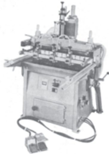
شکل ۹-۱- ماشین سوراخکاری مجهز به مته ۲۳
