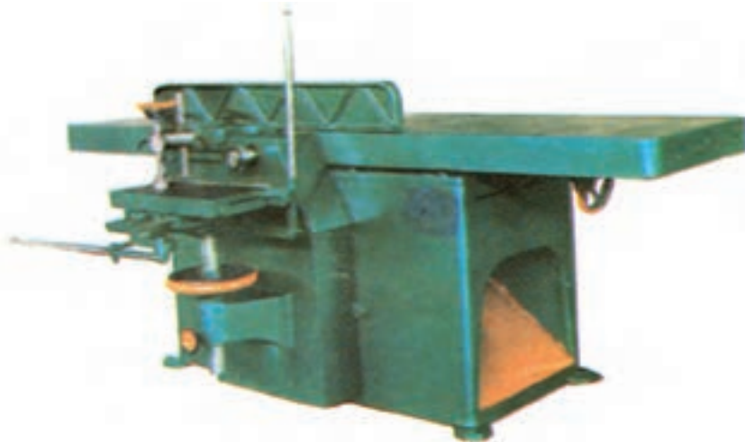
شکل ۳۰-۹- ماشین دوکاره رنده و مته
