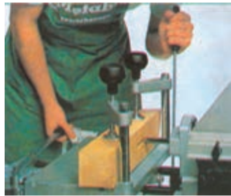
شکل ۹-۶۳- کام کنی با استفاده از مته مخصوص بلند
