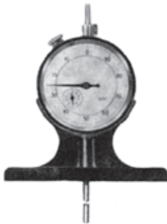
شکل ۹-۷۲- میکرومتر عمق سنج
