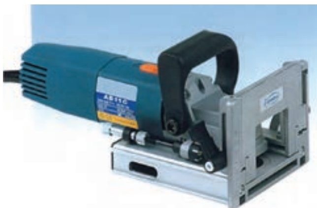
شکل ۹-۱۰۴- دستگاه اتصال بیسکوییتی
