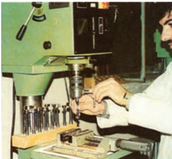
شکل ۹-۷- انتخاب مته از مقرّچوبی و استقرار آن در سه نظام
