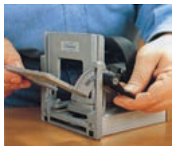
شکل ۹-۱۱۰- نحوه تنظیم زاویه گونیا
