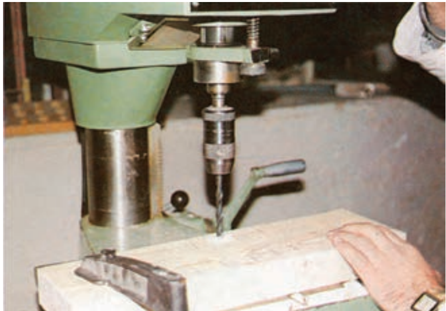
شکل ۳۷-۹- استفاده از گیره در استقرار صفحه روی میز ماشین مته
