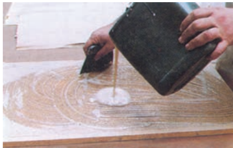
شکل ۱۰-۷- نحوه ریختن چسب روی صفحه کار
