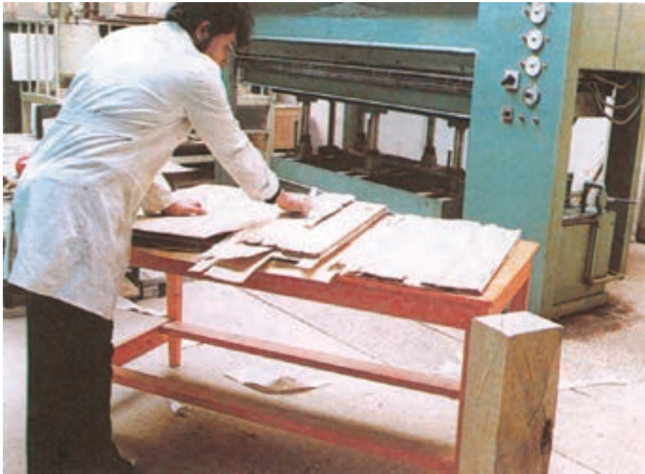
شکل ۳۰-۷ نحوه استقرار صفحات پرس شده روی میز بعد از تخلیه پرس
