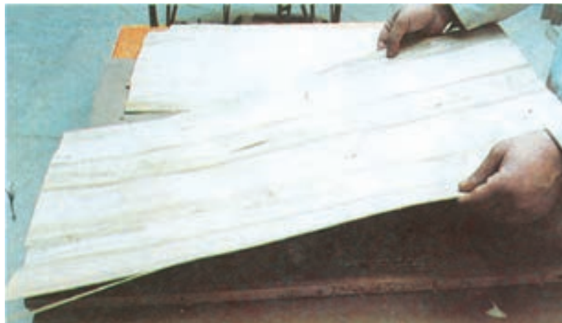
شکل ۷-۱۲- استقرار روکش روی سطح چسب زده شده
