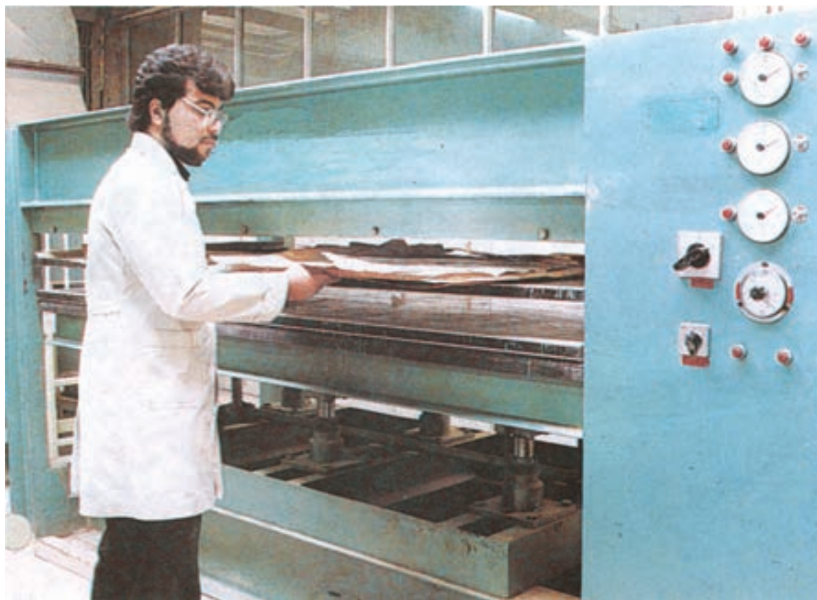
شکل ۲۹-۷- نحوه خارج کردن صفحات پرس شده از بین طبقات پرس
