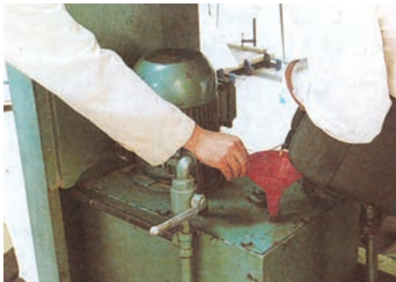
شکل ۱۷-۷- ریختن روغن هیدرولیک داخل کارتر
