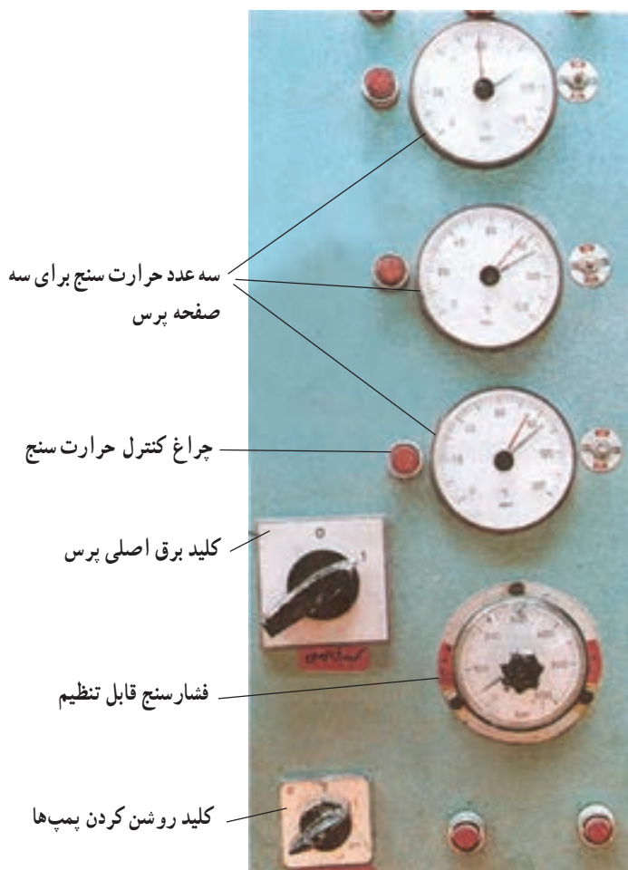
شکل ۷-۲۰- اجزای کنترل و تنظیم پرس
