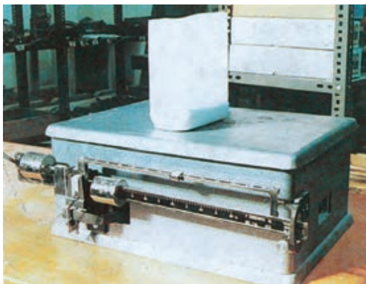
شکل ۳-۷- وزن کردن مواد چسب با ترازوی دقیق
