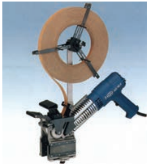
شکل ۲۱-۶- دستگاه لبه چسبان با دهانه قابل تنظیم برای ضخامت‌های مختلف
