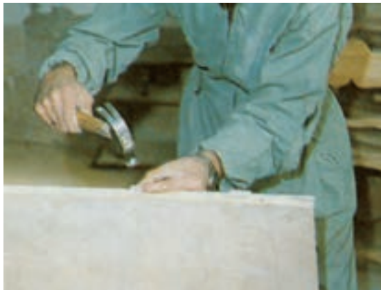
شکل ۹-۶- چسباندن زهوار روی طول صفحه با چکش میخ کش دار
