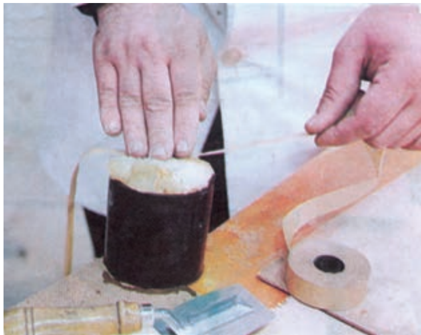
شکل ۸-۵- نحوه‌ی مرطوب کردن نوار چسب کاغذی برای درز روکش
