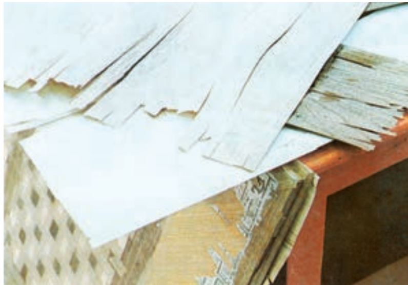
شکل ۴-۵- روکش‌های ترک دار مناسب برای پشت کار
