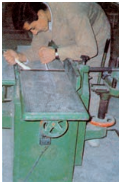
شکل ۲۴-۴- هنرجوی هنرستان ابوریحان کرج در حال سفت کردن تیغه رنده یک ماشین سه کاره.
