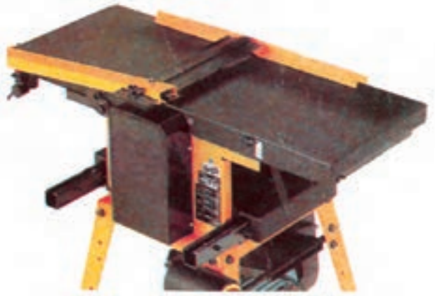
شکل ۳-۴- حفاظ کامل روی تیغه در یک ماشین رنده کوچک.
