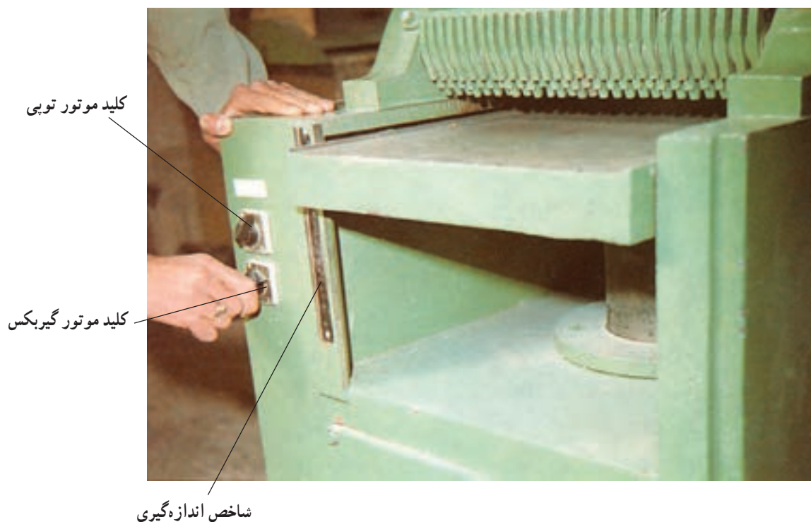
شکل ۴-۷۵- نحوه روشن کردن از کنار ماشین گندگی
