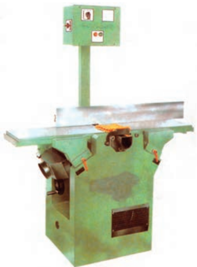
شکل ۴-۳۵- صحت ظاهری ماشین رنده را کنترل کنید.
