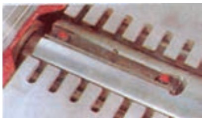
شکل ۴-۳- لبه‌شانه‌ای صفحات ماشین رنده برای تقلیل صدا.
