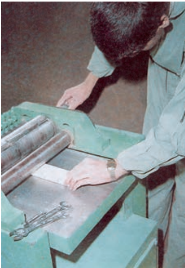
شکل ۴-۶۶- نحوه آزمایش تنظیم تیغه‌های گندگی با یک قطعه چوب
