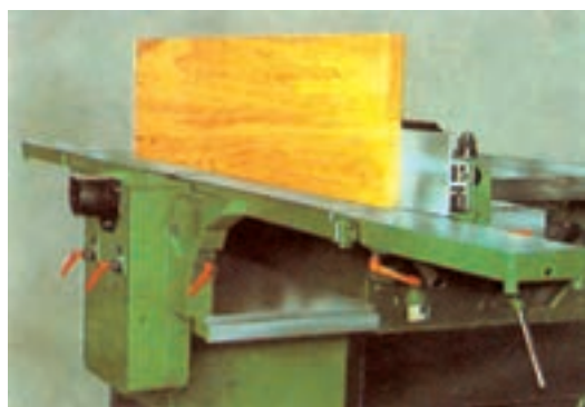
شکل ۲۶-۴- وضعیت چوب پس از تنظیم گونیای ۹۰ درجه.
