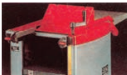
شکل ۷۲-۴- استقرار حفاظ روی غلتک‌های گندگی
