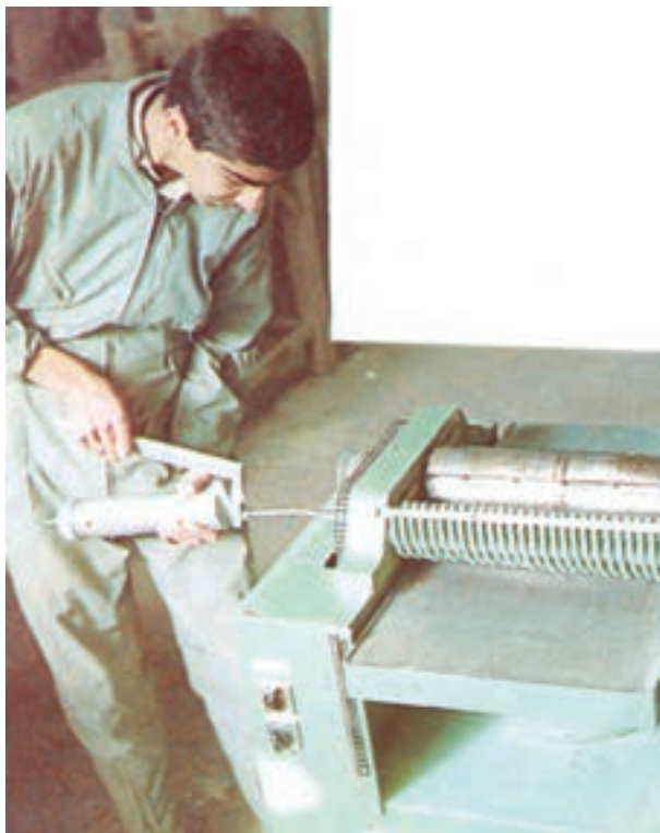
شکل ۷۱-۴- گریسکاری غلتک‌های گندگی
