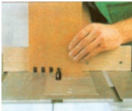
شکل ۳-۵۴- ایجاد اتصال انگشتی با ارّه لنگ
