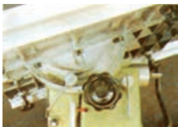
شکل ۳-۲۱- تنظیم صفحه کج شونده ماشین ارّه گرد
