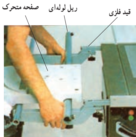
شکل ۳-۳۵ - طریقه نصب میز کشویی
