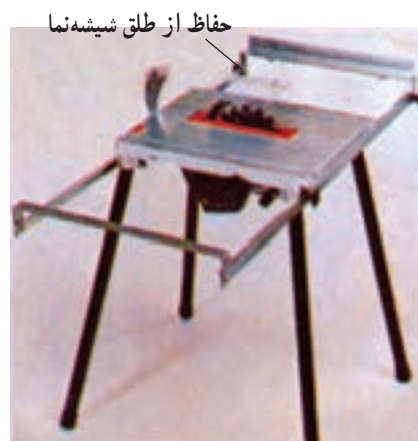
شکل ۳-۳۴ - استفاده از حفاظ پلاستیکی روی تیغه
