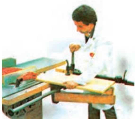
شکل ۳۷-۳- ماشین اره گرد میزی با میز متحرک کشویی
