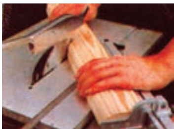
شکل ۳-۶۴- برش عرضی زاویه دار چوب پروفیل خورده
