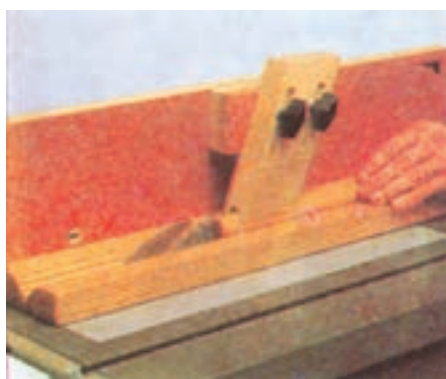
شکل ۳-۶۱- برش زهوار گرد به وسیله اَره گرد با کمک شابلون یا فیکسچر مخصوص شانه‌ای
