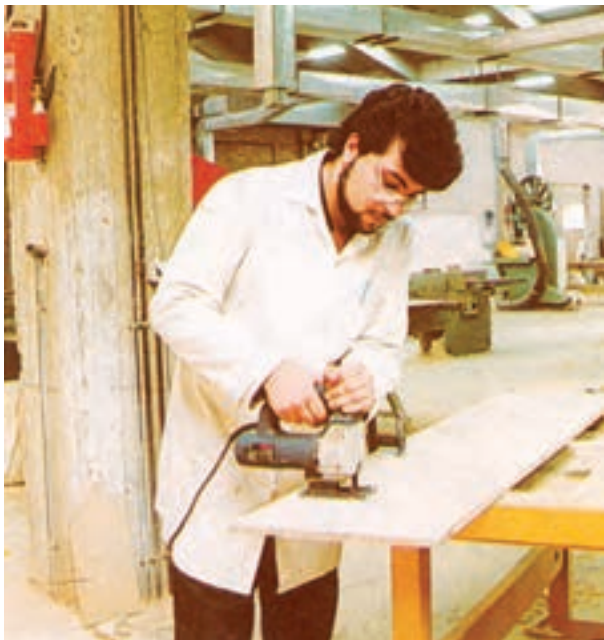
۱۱-۲- در موقع روشن بودن دستگاه تکیه‌گاه اره را از روی کار بلند نکنید.
