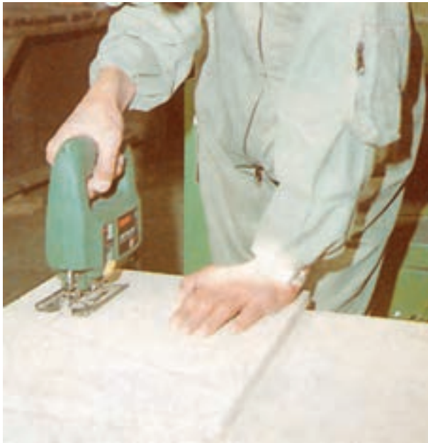
شکل ۱۰-۲- نحوه برش قطعات کوچک تخته خرده چوب
