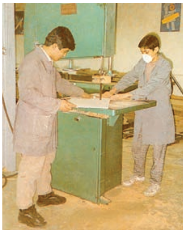
شکل ۶۰-۲- انجام عملیات برشکاری بدون استفاده از گونیا
