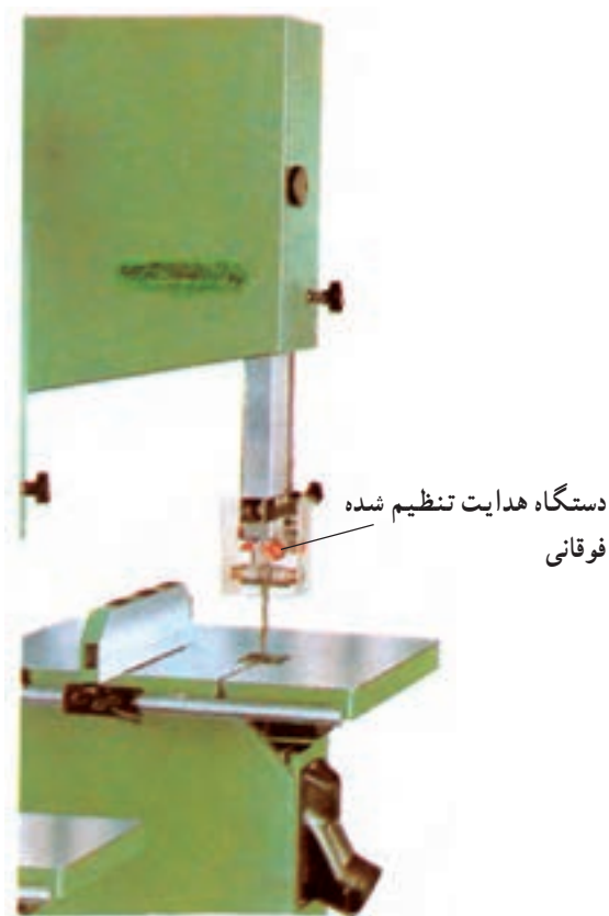
شکل ۲-۵۳- دستگاه هدایت تنظیم شده
