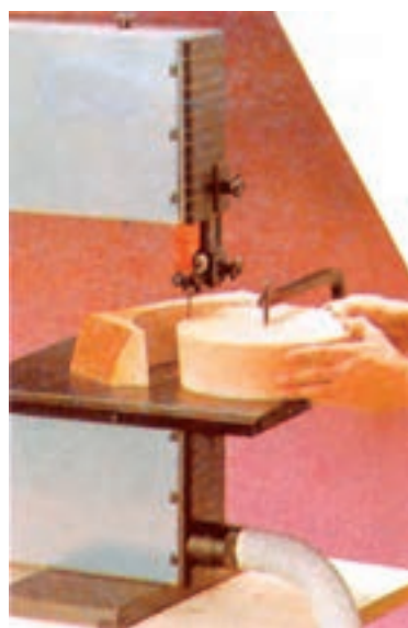
شکل ۲-۶۸ - عمل دایره‌بری با استفاده از شابلون پایه‌دار
