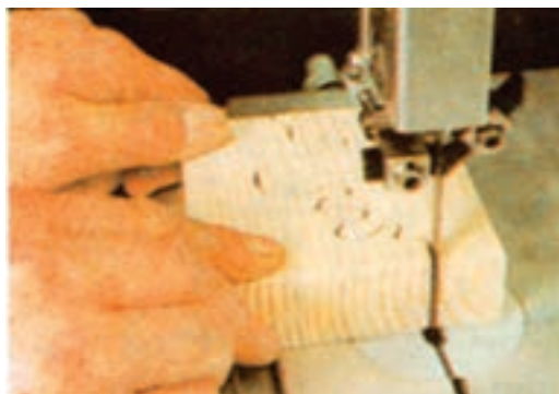
شکل ۲-۶۳- قوس بری با استفاده از اره نواری کوچک (مشک بری)
