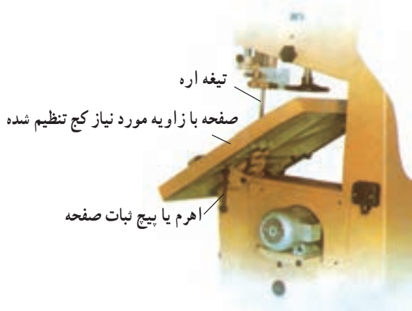
شکل ۲-۵۶ – نحوه‌ی تنظیم زاویه صفحه نسبت به تیغه اره
