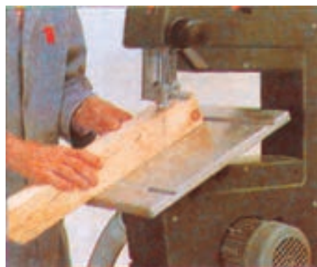
شکل ۲-۷۳- نحوه‌ی برش عرضی و زاویه‌دار چوب
