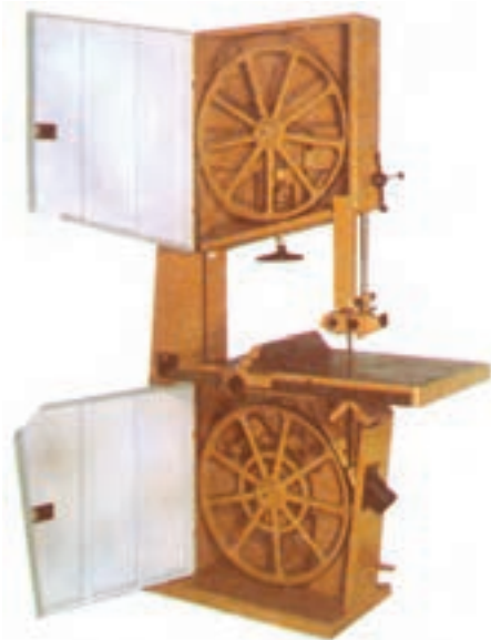
شکل ۴۶-۲- فلکه‌های اره از چدن ریختگی است و دیرتر لنگ می‌شود.
