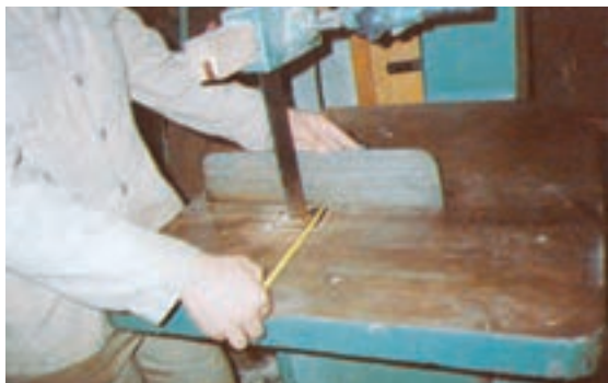
شکل ۲-۵۹- نحوه‌ی تنظیم گونیای غیراستاندارد روی صفحه ماشین اره‌نواری
