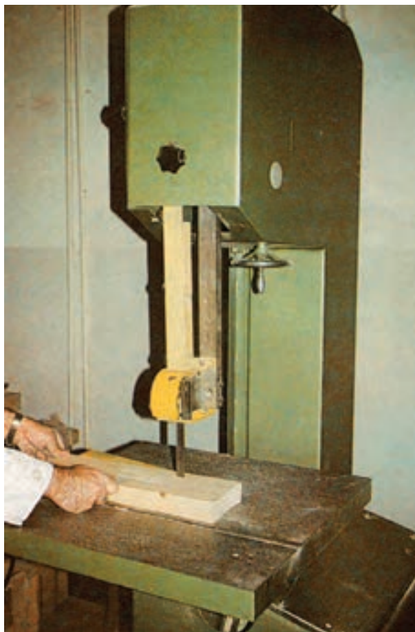
شکل ۲-۶۲- نحوه قرار دادن دست‌ها در برشکاری با استفاده از گونیا
