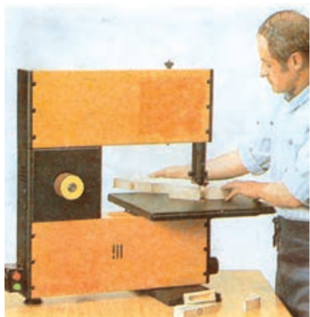
شکل ۲-۷۶- عملیات قوس‌بری صفحات
