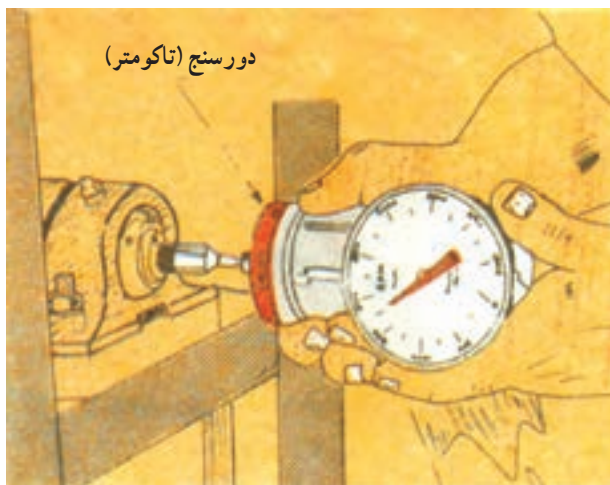
شکل ۲-۲۴- استفاده از سرعت سنج (تاکومتر) در دستگاه در حال کار
