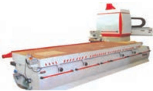
شکل ۵۳-۱ - اورفرز CNC برای فرم تراشی و ابزار زدن صفحات و تولیدات صنایع چوب
