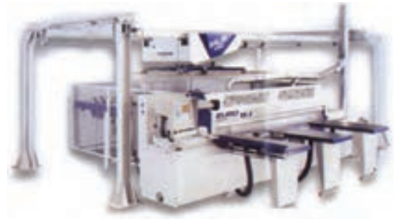
شکل ۵۵-۱- فقط کافیست به این ماشین دستور برش بدهید نیازمند جابه جایی و چرخش صفحات برای برش نیز نخواهد بود.
