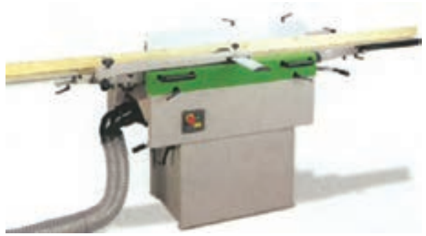
شکل ۴۰-۱- ماشین رنده مجهز به لوله مکنده است.
