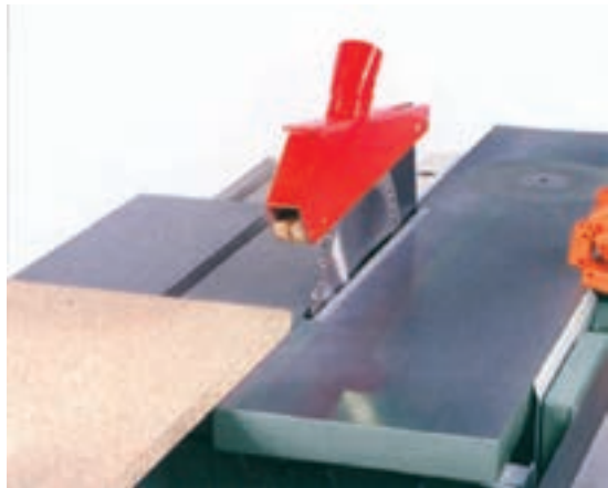
شکل ۱-۳۵- حفاظ روی تیغه ارّه مجموعه‌ای
