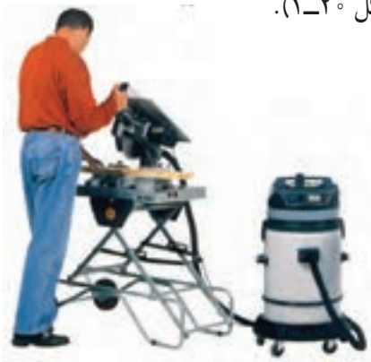
شکل ۲۰-۱- مکنده خاک‌اره موضعی برای هر ماشین
