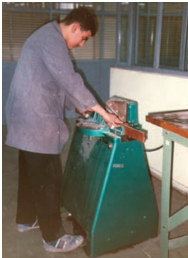
شکل ۴۷-۱- فرمان حرکت اتوماتیک تیغه‌اره (پنوماتیک)
