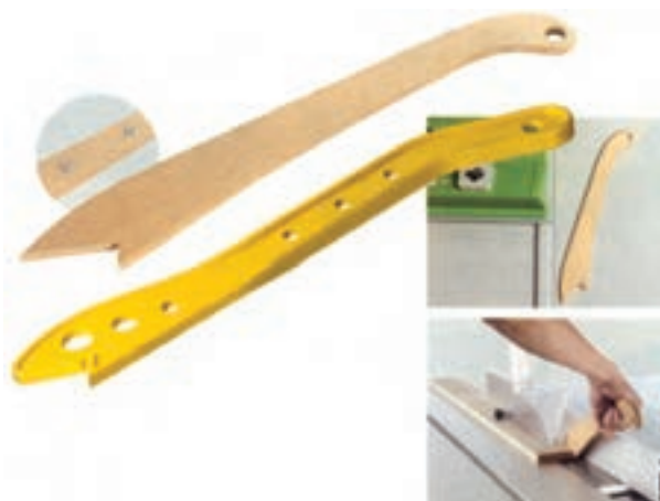
شکل ۱-۲۷- شابلون هل دهنده و نگهدارنده پشت چوب
