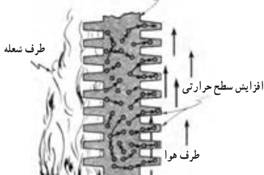
شکل ۱-۷-۱ انتقال گرما به طریق هدایت
