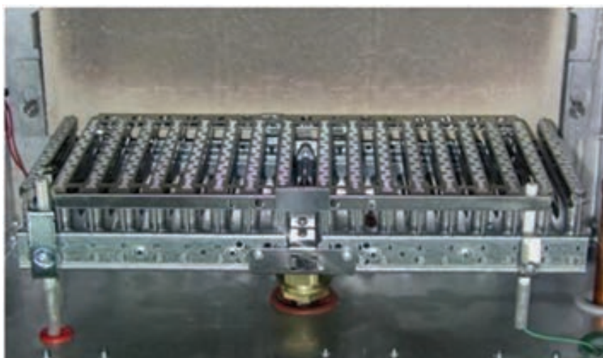
شکل ۱۲-۱۴- الکتروود یون در مشعل
