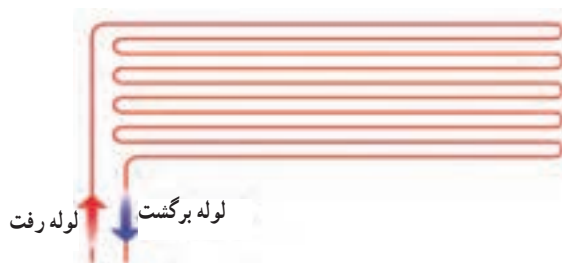
شکل ۴-۲۰- آرایش مارپیچی (کویلی) کف گرمایی
