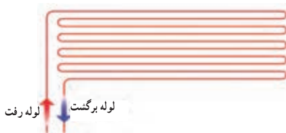
شکل ۲۰-۴- آرایش مارپیچی (کویلی) کف گرمایی
