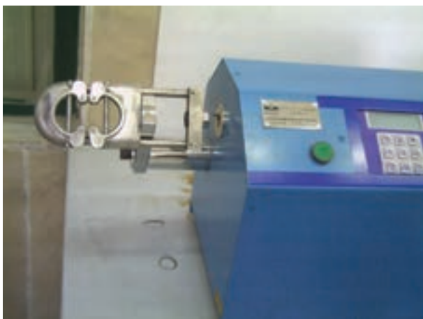
شکل ۱-۱۵- نحوه‌ی اندازه‌گیری استحکام کششی نمونه
