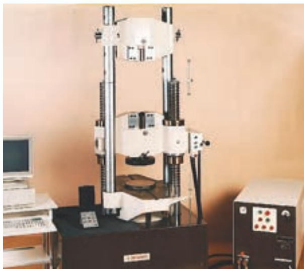
شکل ۱۱-۲- دستگاه آزمایش فشاری و نمونه آزمایش
