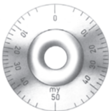
شکل ۹-۱۳- ضخامت‌سنج فیلم خشک رنگ (روش تخریبی)
