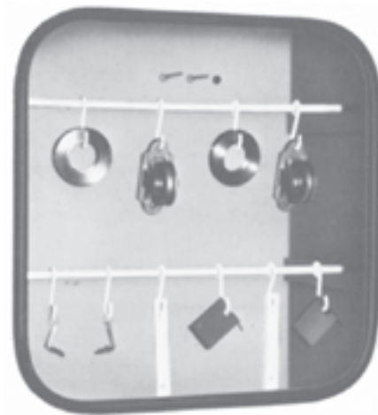
شکل ۲-۱۳- دستگاه تولید رطوبت صد درصد (Humidity) مورد استفاده: بررسی مقاومت فیلم خشک رنگ در محیط‌های مرطوب
