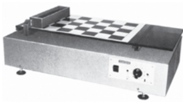
شکل ۱۳-۶- دستگاه فیلم کش (اپلیکاتور) اتوماتیک با ضخامت های مختلف
