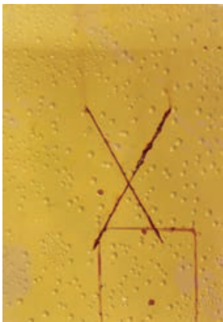
شکل ۶-۱- تاول‌زدگی (عدم مقاومت فیلم در محیط رطوبتی)
