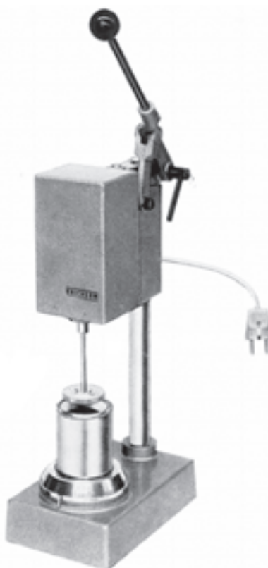
شکل ۱۳-۳- چند نوع وسیله‌ی اندازه‌گیری گرانروی
