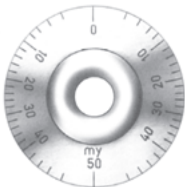
شکل ۹-۱۳- ضخامت‌سنج فیلم خشک رنگ (روش تخریبی)
