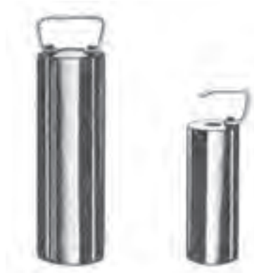
شکل ۲-۳۸- استوانه کنترل
