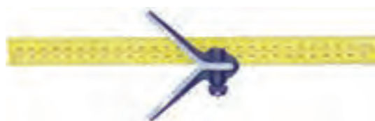
شکل ۷-۳۲- سر مرکز یاب
