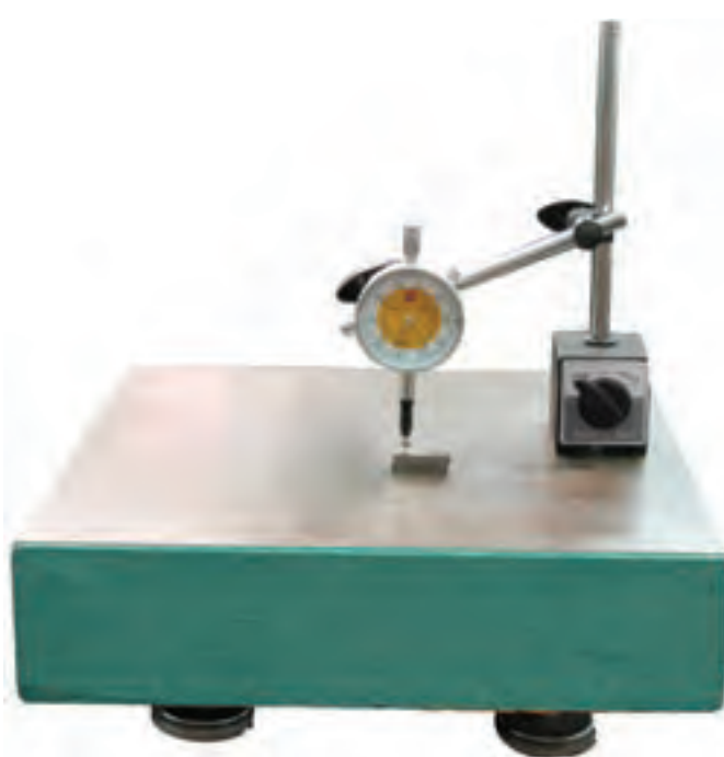
شکل ۸-۱۸- تنظیم ساعت اندازه‌گیری
