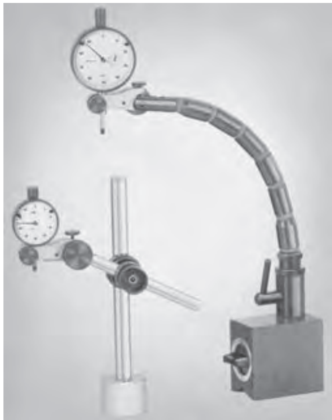
شکل ۵-۶- بستن ساعت از محل گلوبی غلاف میله اندازه گیری
