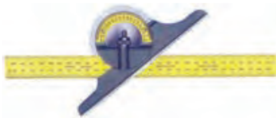
شکل ۷-۳۱- سر زاویه یاب و خط کش
