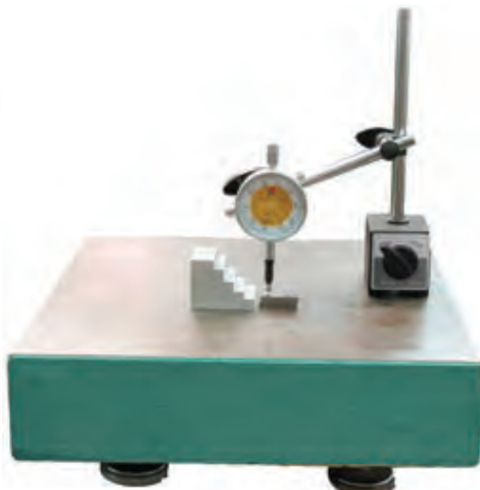
شکل ۸-۱۷- اندازه‌گیری ارتفاع پله‌ها
