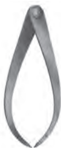
شکل ۲-۲۵- پرگار انتقال اندازه خارج
