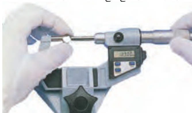
شکل ۳۱-۵ اندازه‌گیری به وسیله میکرومتر دیجیتالی
