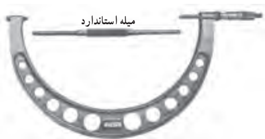
شکل ۲۱-۵ میکرومتر (۱۰۰-۷۵) میلی متر
