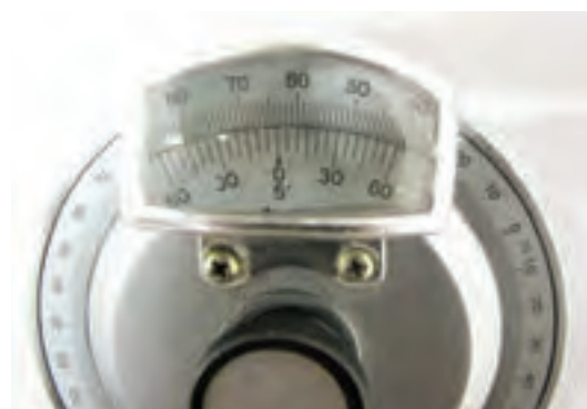
شکل ۱۰-۷- خواندن زاویه‌سنج ۵ دقیقه
