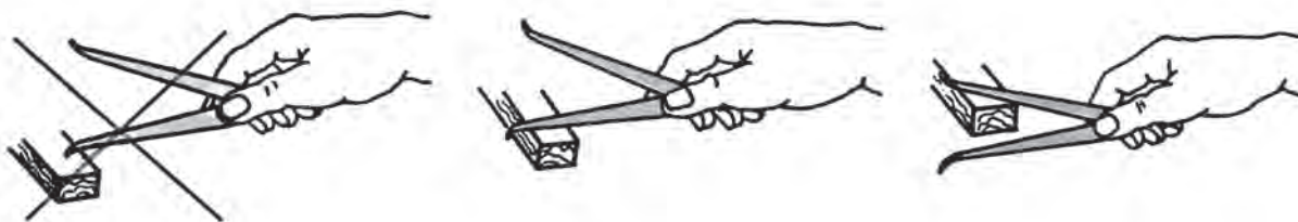
شکل ۲-۲۹- تنظیم دهانه پرگار انتقال اندازه داخل
