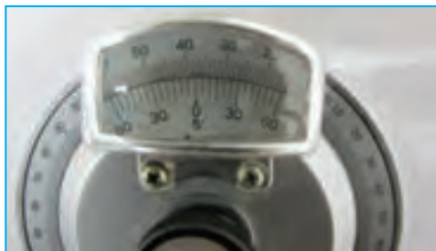
شکل ۸-۷- خواندن زاویه‌سنج ۵ دقیقه
