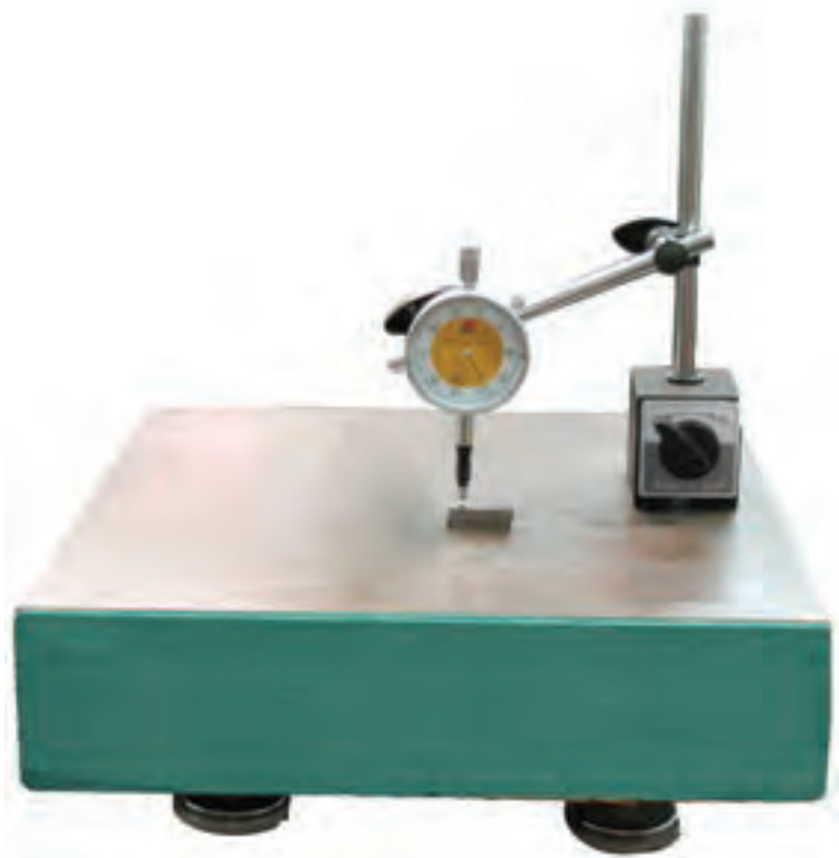
شکل ۲۱-۶- آماده‌سازی ساعت برای عملیات کنترل
