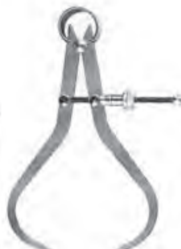
شکل ۲-۲۴- پرگار انتقال اندازه
