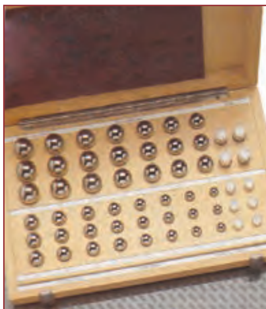
شکل ۴۲-۸- گلوله‌های اندازه‌گیری
