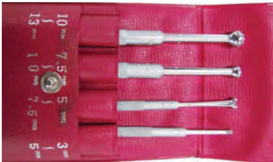
شکل ۳۷-۲- اندازه گیر سوراخ
