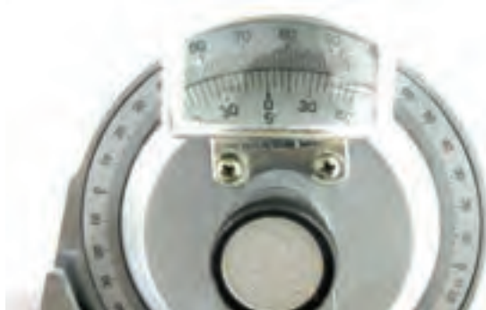
شکل ۹-۷- خواندن زاویه‌سنج ۵ دقیقه
