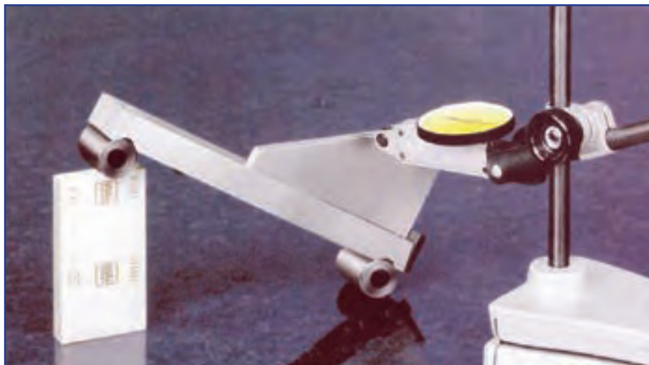
شکل ۱۶-۷ اندازه‌گیری زاویه به کمک خطکش سینوسی
