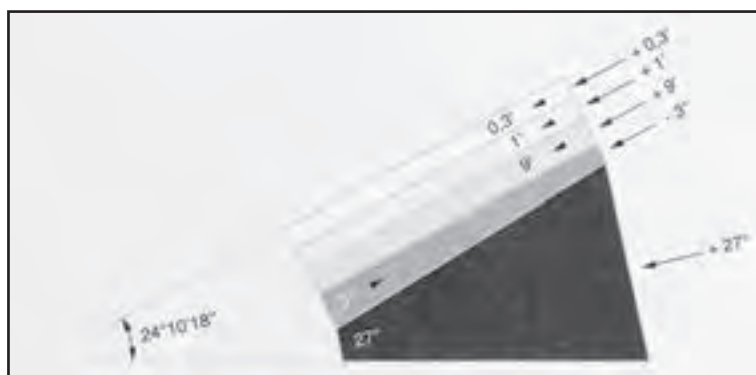
شکل ۸-۲۴- ترکیب بلوک‌سنج‌های زاویه
