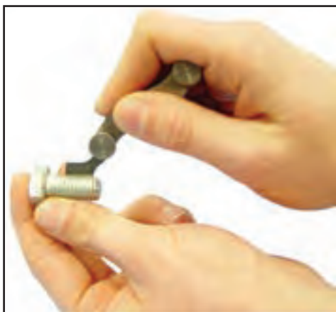
شکل ۸-۳۳- اندازه‌گیری گام
