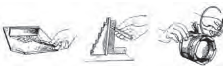
شکل ۸-۲۹- نمونه‌هایی از کاربرد فیلر
