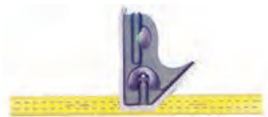
شکل ۷-۳۰- سرگونمایی و خط‌کش
