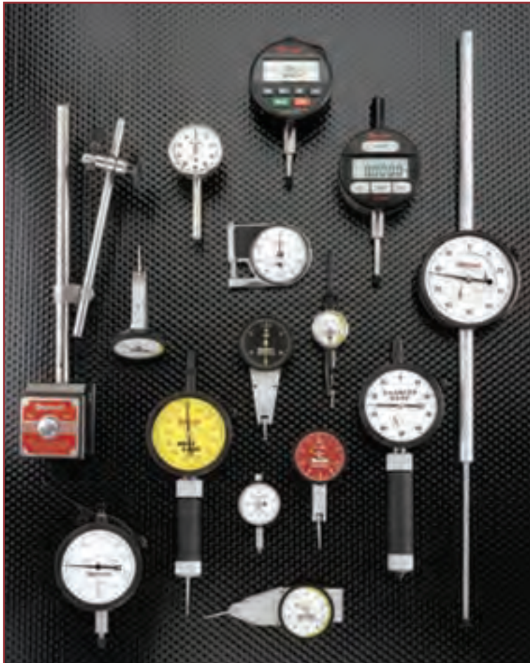
شکل ۱-۶- انواع ساعت اندازه‌گیری
