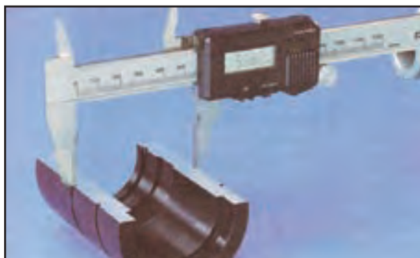
شکل ۴-۲۲- اندازه‌گیری با کولیس دیجیتالی
