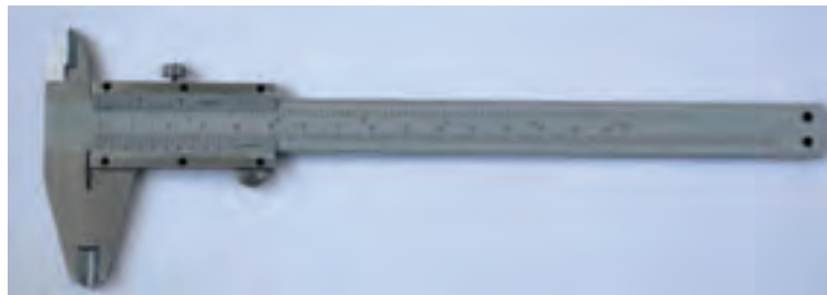
شکل ۴-۱- کولیس ورنیه
