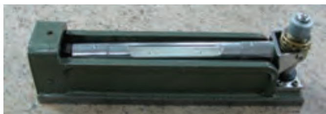
شکل ۲-۱۴- تراز میکرو متردار
