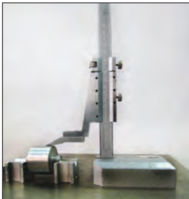
شکل ۱۲-۴ کاربرد کولیس ورنیه ارتفاع‌سنج
