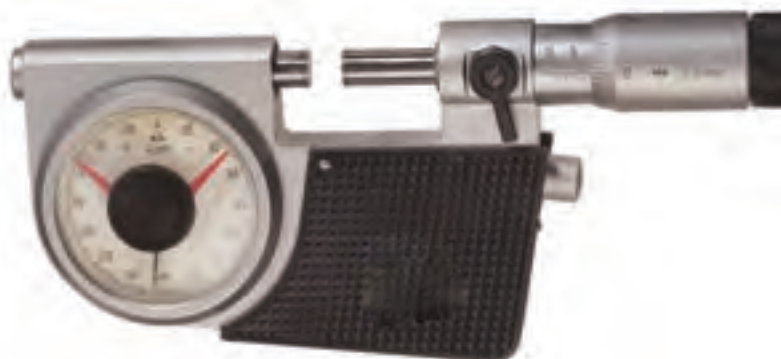
شکل ۲۹-۵- میکرومتر عقربه‌دار با صفحه دایره‌ای شکل
