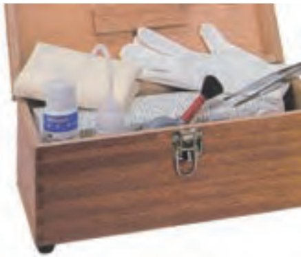
شکل ۲۰-۸ لوازم تمیز کردن و نگهداری بلوک سنجه
