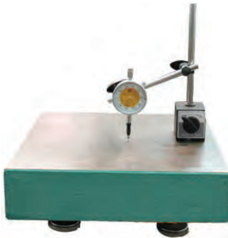
شکل ۲۰-۶- آماده‌سازی ساعت برای عملیات اندازه‌گیری
