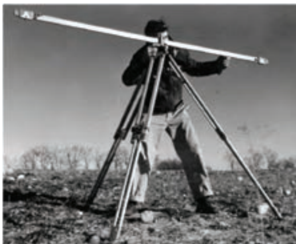
شکل ۵-۳- روش پارالاکتیک و شاخص آن
