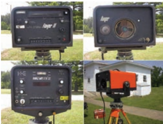
شکل ۳-۸- فاصله یاب مایکروویو
