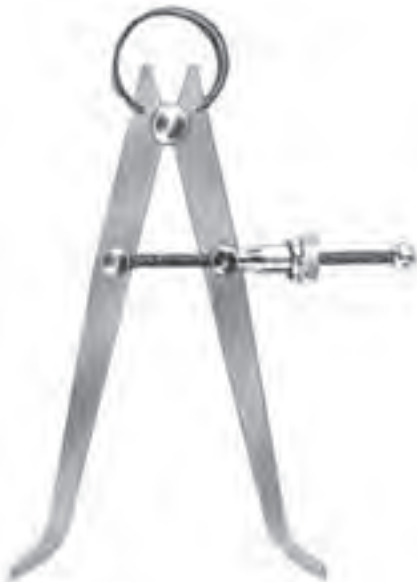
شکل ۲۸-۲- پرگار انتقال اندازه داخل
