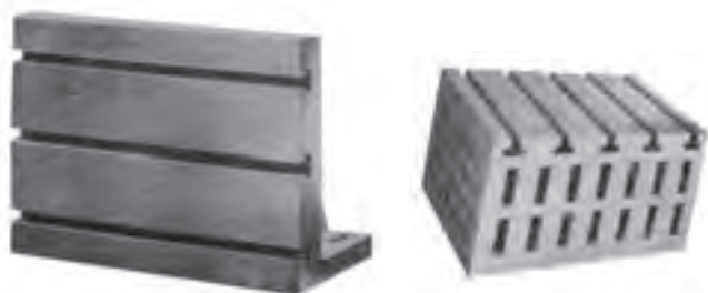
شکل ۲-۴۵- صفحات گونیایی شیاردار
