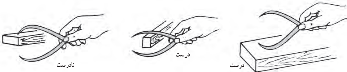
شکل ۲۷-۲- تنظیم دهانه پرگار انتقال اندازه خارج
