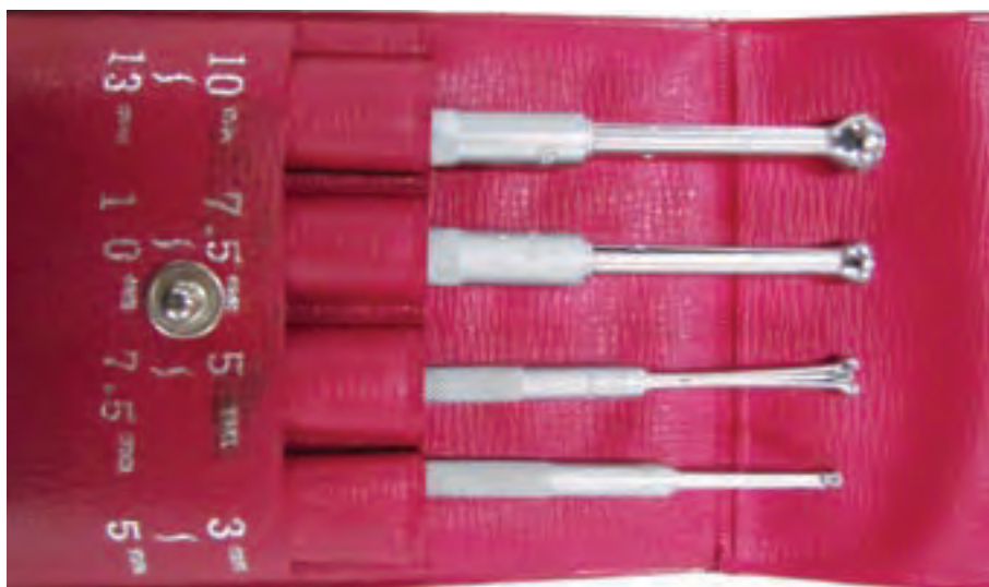
شکل ۳۷-۲- اندازه گیر سوراخ
