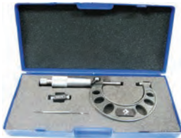
شکل ۱۵-۱- میکرومتر با گستره اندازه‌گیری ( 0-75 ) میلی‌متر
