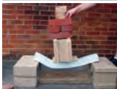
شکل ۵-۵- آزمایش فمخش تیر
