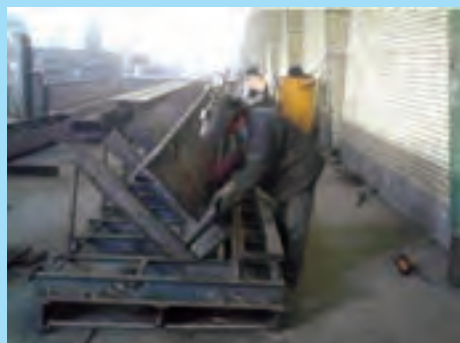
جوش طولی به روش زیرپودی
