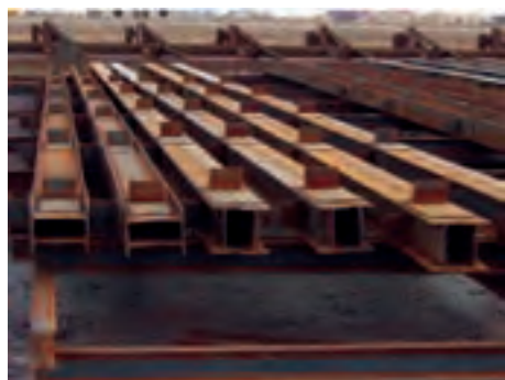
شکل ۴-۱۴- ستون با پروفیل جفت
