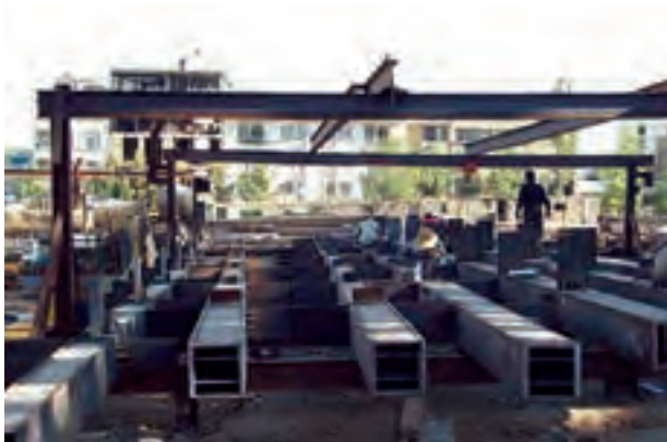
سافت ستون با مقطع جعبه‌ای در کارخانه
