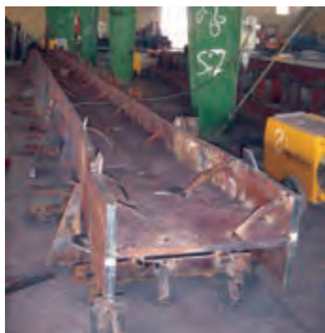
مونتاز تیورق با تغییر مقطع در قالب
