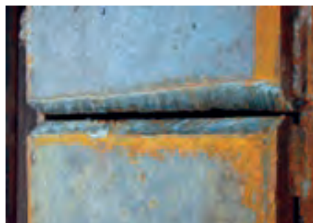
آماده‌سازی نامناسب درز جوش شیار
