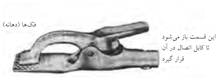
شکل ۷-۳۲- گیره اتصال به قطعه کار
