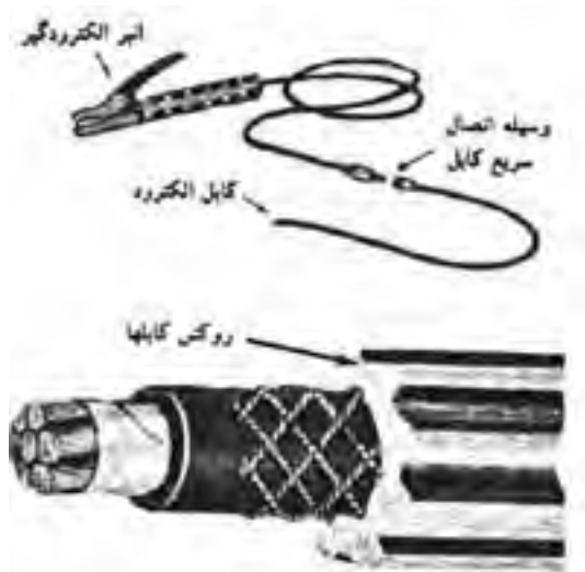
شکل ۷-۲۷ - مقطع کابل جوشکاری قوسی
