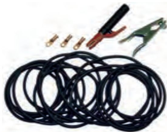
شکل ۷-۳۰ - انبر، کابل شو و کابل جوشکاری
