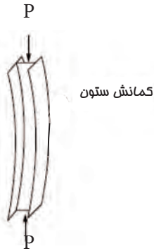
شکل ۴-۳- کمانش عضو فشاری
