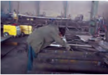
الف- شاسی کشی برای برشکاری
