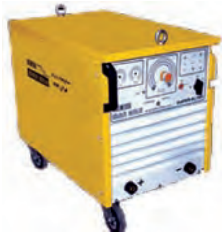
شکل ۷-۲۲- (رکتیفایر جوشکاری با الکتروود دستی)
