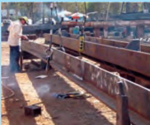
مونتاژ و جوش سوم و چهارم در روش مونتاژ تک مرحله‌ای ستون‌های صلیبی
