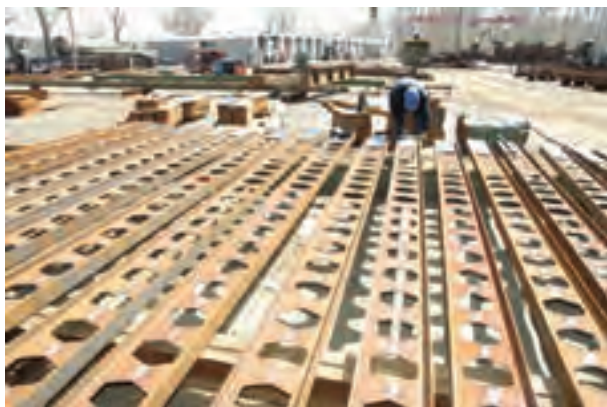
ادامه شکل ۵-۲۲- جوشکاری محل اتصال دونیمه
