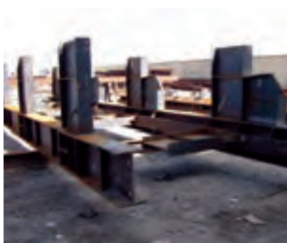
شکل ۱۱-۱۵- فیکسچر مونتاز نهایی قطعات الماکی دستک‌ها روی ستون صلیبی شکل
