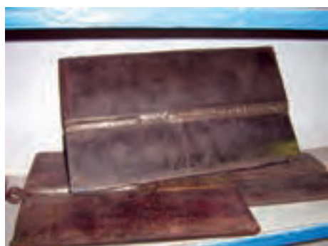
شکل ۱۲-۱۱- نمونه درز جوش شده شیار
