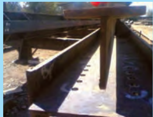
مونتاژ و جوش سوم و چهارم در روش مونتاژ تک مرحله‌ای ستون‌های صلیبی
