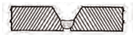
ب- درز شیاری با پیشانی ریشه و عدم ریزش پاس ریشه
