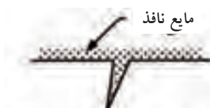
الف- مایع نافذ رنگی یا فلوئورسنت در داخل ناپیوستگی تراوش می‌کند
