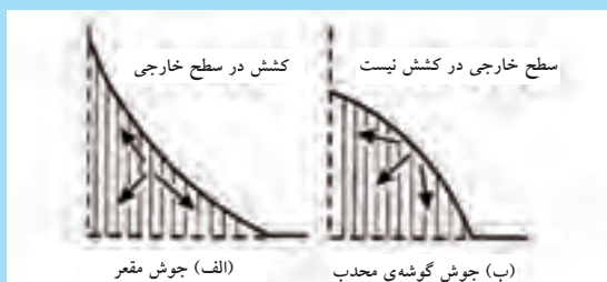
شکل ۱۲-۱۸- انواع ترک در جوش
