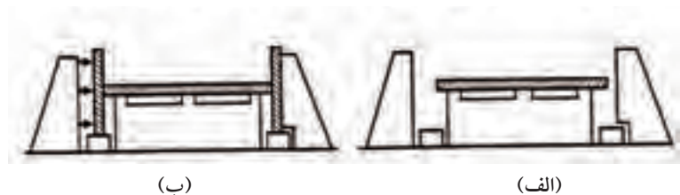
شکل ۱۱-۶- مونتاز تیرورق در قالب
