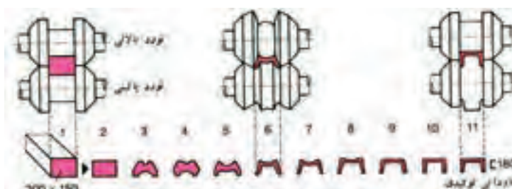
شکل ۱-۱۳- مراحل مختلف تهیه ناودانی از یک بلوک با روش نوردکاری
