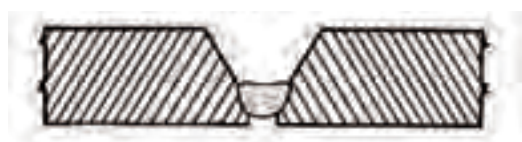
ب- ریزش مذاب در ریشه‌ی جوش درز فوق
