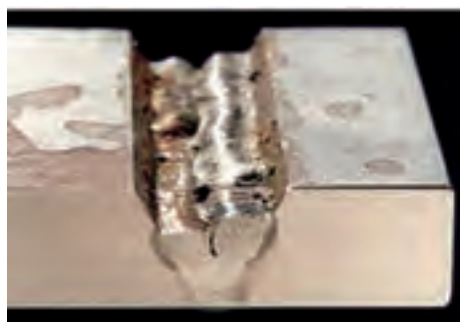
شکل ۱۲-۱۰- ذوب ناقص در پاس (روی جوش)
