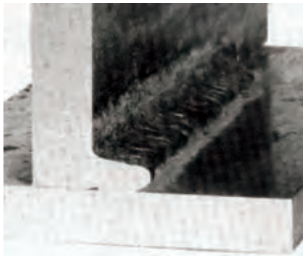
شکل ۱۲-۱۵- سررفتگی در یک جوش گوشه
