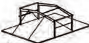
نصب قاب بعدی و نصب کلاف طولی سقف
