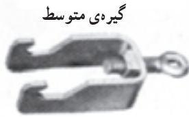
شکل ۸-۷- چند نوع گیره برای اتصال پشت‌بند به بدنه‌ی قالب
