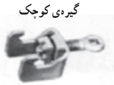
شکل ۸-۷- چند نوع گیره برای اتصال پشت‌بند به بدنه‌ی قالب
