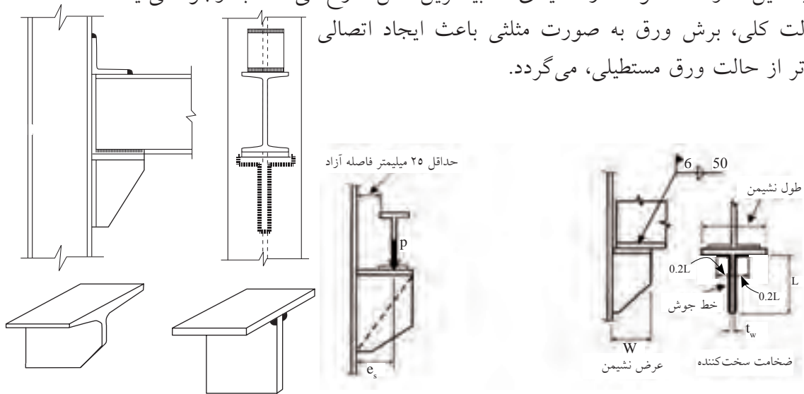
شکل ۸-۴- انواع اتصال ساده با نشیمن تقویت شده
