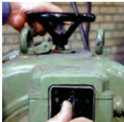
شکل ۷-۲۱- قرار دادن کلید دینام جوشکاری
