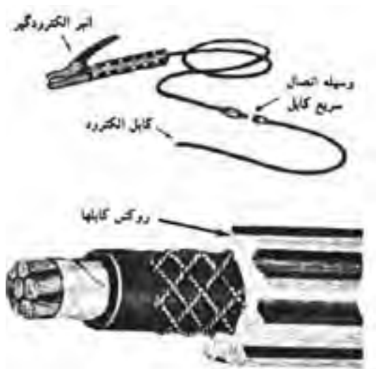
شکل ۷-۲۷ - مقطع کابل جوشکاری قوسی
