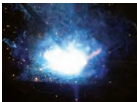
قوس الکتریکی در جوشکاری با الکترود روکش‌دار
