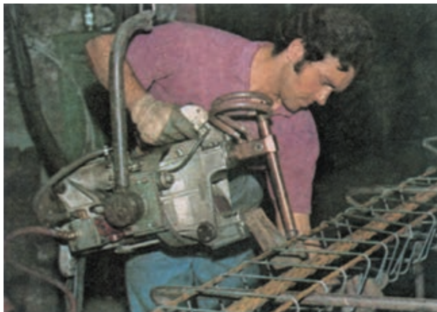
شکل ۲۷-۲- دستگاه نقطه جوش برای اتصال میل‌گردها به یکدیگر
