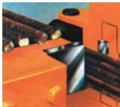
شکل ۵۶-۲- یک نمونه ماشین برقی برش میل گرد
