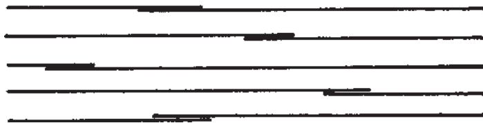
شکل ۴-۲- محل‌های اتصال میل‌گردها تا آنجا که ممکن است پراکنده باشند.
