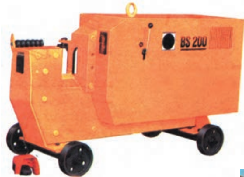
شکل ۵۶-۲- یک نمونه ماشین برقی برش میل گرد
