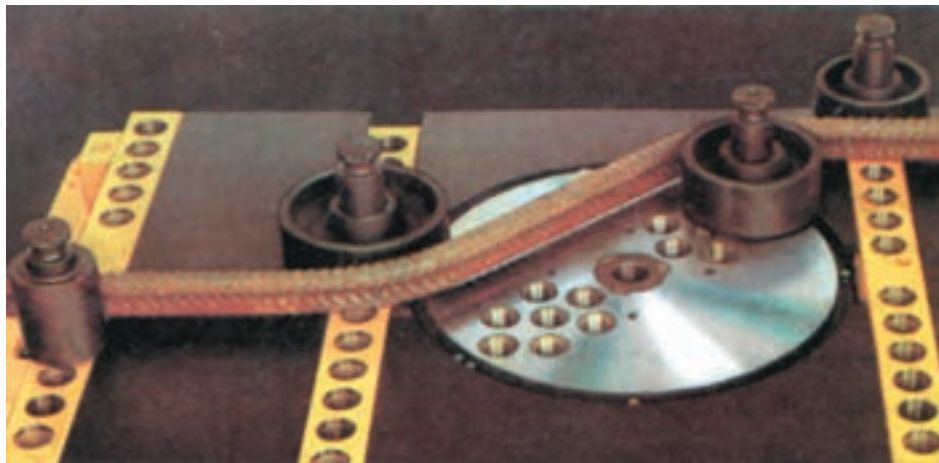
شکل ۶۴-۲- ساختن اتکا به وسیله ی دستگاه میل گرد خم کن برقی
