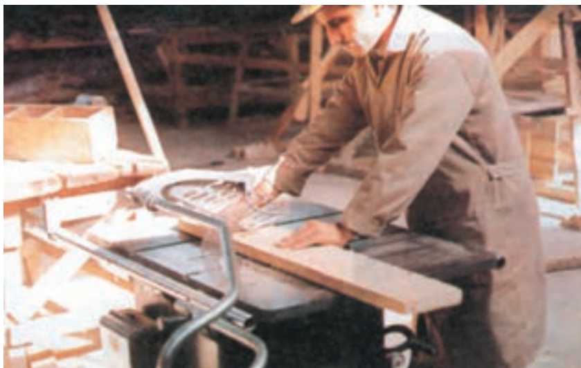
شکل ۱-۶۵- روش بریدن عرضی تخته با اژه‌ی گرد برقی میزی
