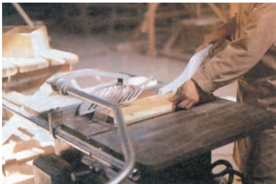
شکل ۱-۶۷- برش طولی تخته با استفاده از چوب هدایت‌کننده
