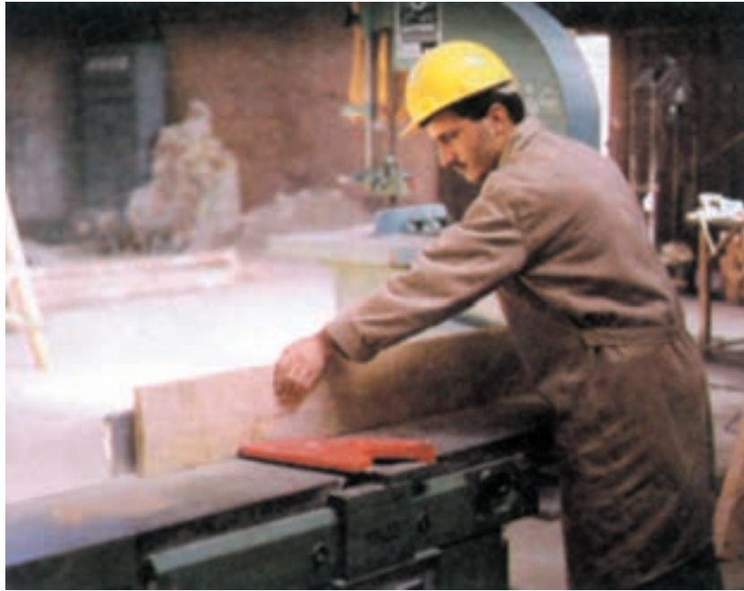
شکل ۱-۷۵- رنده کردن ضخامت (تر) تخته با رنده‌ی برقی
