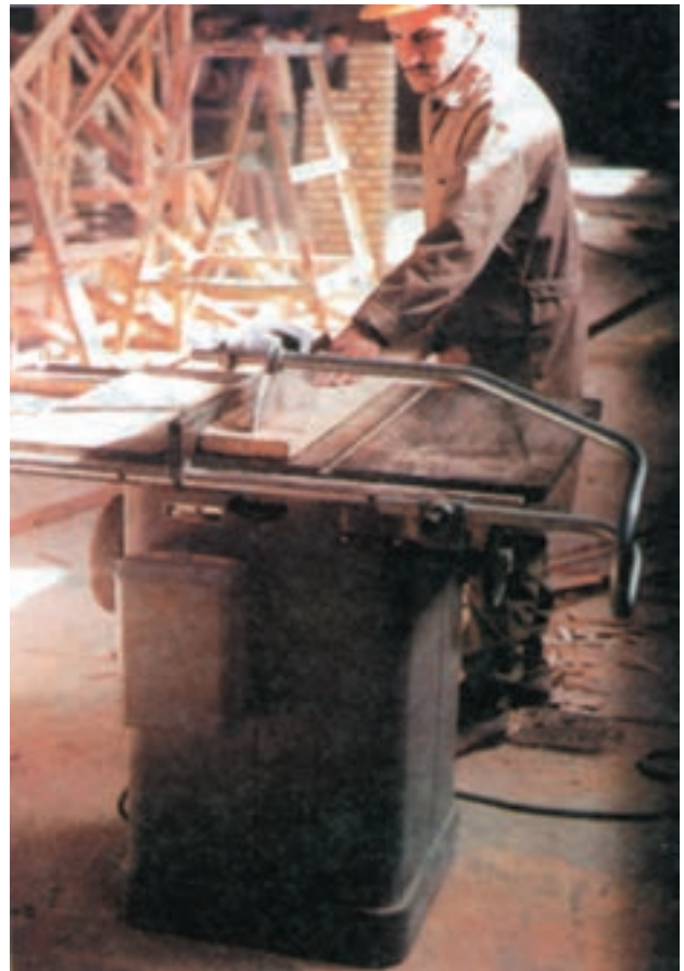
شکل ۶۴-۱- روش بریدن طولی تخته با ارّه‌ی گرد برقی میزی
