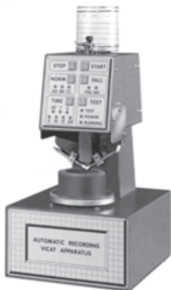
دستگاه الکترونیکی ویکات که برای تعیین زمان گیرش سیمان به کار می‌رود و براساس استاندارد ASTM C187 و DIN 1164 کار می‌کند.
