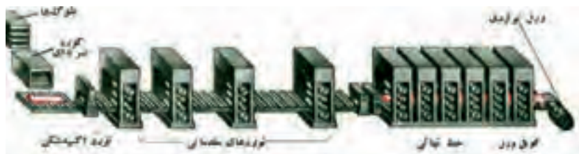
شکل ۱-۱۴- خط تولید نورد ورق
