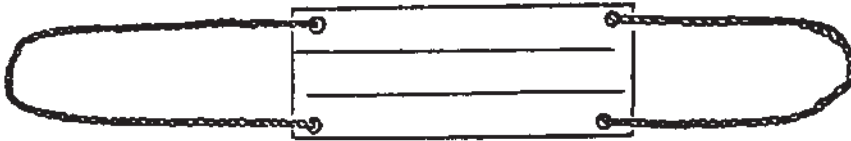
شکل ۸-۱۲- آویز تخته‌ای مخصوص حمل کالاهای شکستنی
