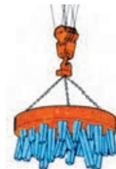
شکل ۱۶-۱۲- آویز مغناطیسی خرد ریز بردار
