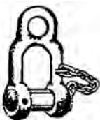
شکل ۱۷-۲- شِکِل اتصال به بویه
