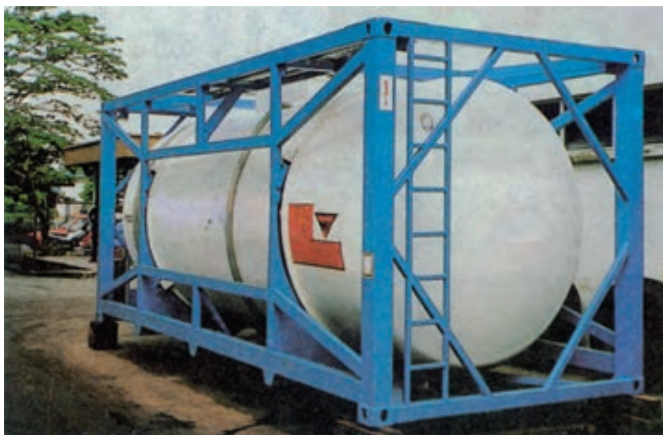
شکل ۳۴-۸ - مخزن گاز مایع کانتینری
