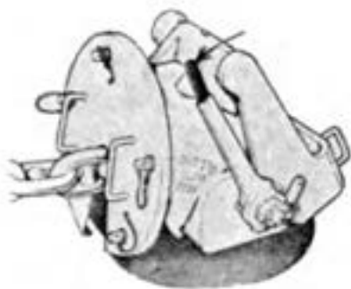
شکل ۲-۳۳- کمپرسور دهانه لوله عبور زنجیر از چاه
