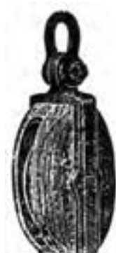
External Bound Block شکل ۴-۲ — قرقه چوبی با تسمه فلزی خارجی
