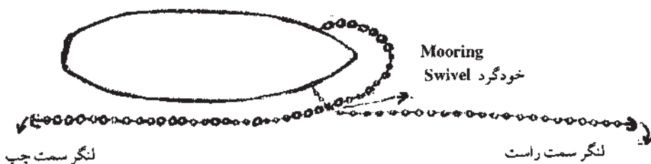
شکل ۳-۹- نمایی از یک کشتی فرضی در حالت مهار با دو لنگر
