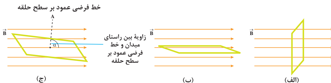
شکل ۳-۲۱- نمایش نحوه عبور شار مغناطیسی از سطح
