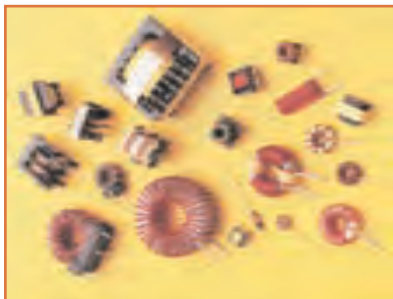
شکل ۲۰-۳. انواع بوبین‌ها با هسته‌های مختلف
