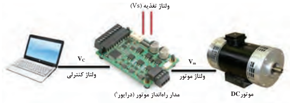
شکل ۱۰-۱- نمایی از سیستم کنترل دور موتور
