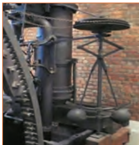
شکل ۱-۲- نمایشی از گاورنر جیمز وات
